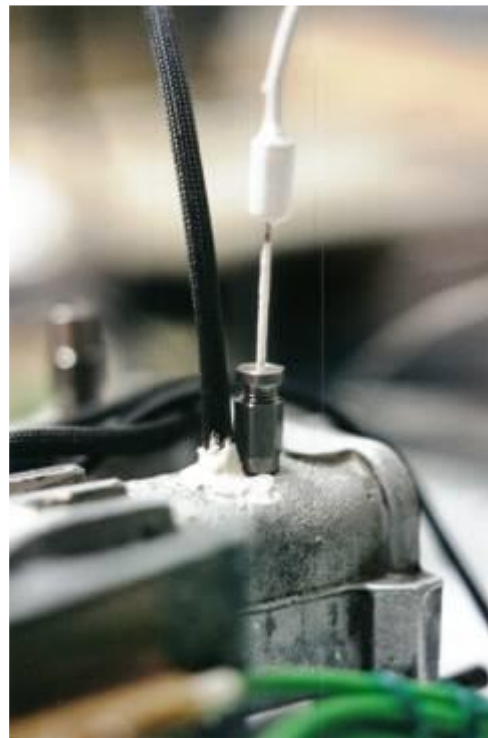
Σχήμα 3-15. Αισθητήρες θερμοκρασίας και θερμοροής τοποθετημένοι στην επιφάνεια του αγωγού εξαγωγής.
