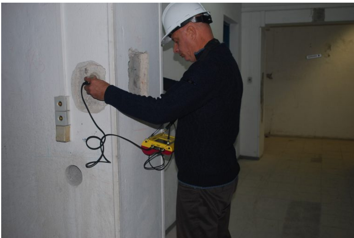
Εικόνα 18:Εφαρμογή μετρήσεων με χρήση υπερήχων
