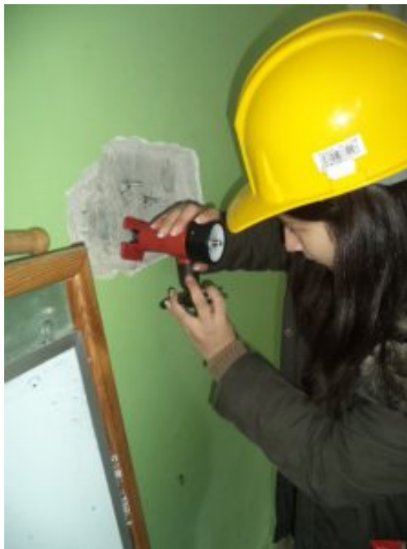
Εικόνα 16:Εφαρμογή μεθόδου εξόλκευσης ήλων
