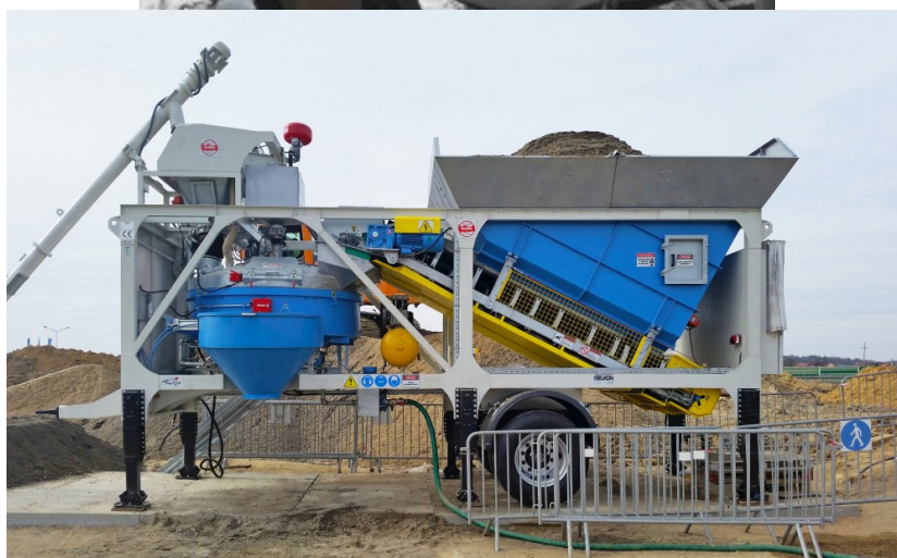
Εικόνα 10:Συσκευή παρασκευής εργοταξιακού σκυροδέματος (μικρής χρήσης πάνω και μεγάλης χρήσης κάτω)
