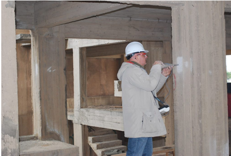
Εικόνα 15:Εφαρμογή μεθόδου κρουσιμέτρου
