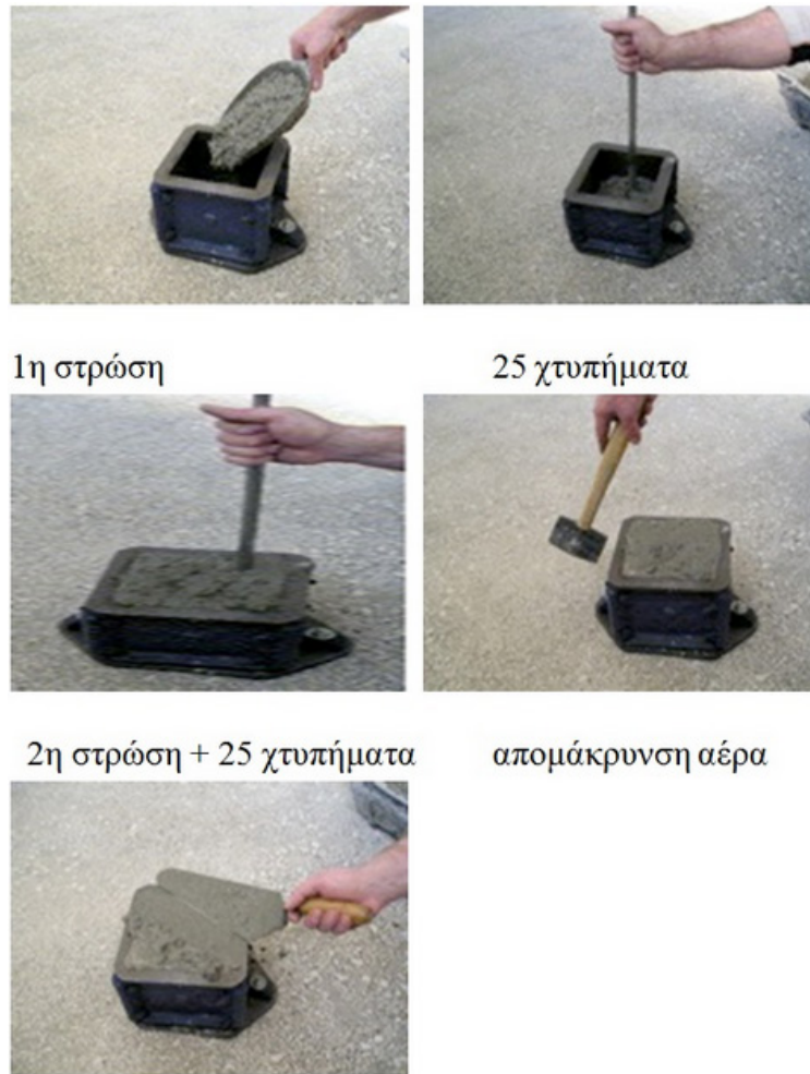
επιπέδωση Εικόνα 12: Δημιουργία δοκιμίων για έλεγχο ( https://www.zarrasae.gr/node/55 )
