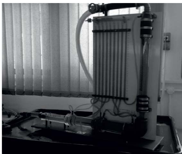
Σχήμα 2.12. Πειραματικός εξοπλισμός μέτρησης απωλειών πίεσης του ΤΕΙ Θεσσαλίας [11]
