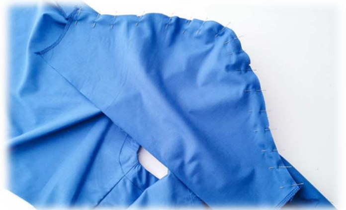
Εικόνα 85. Τοποθέτηση μανικιού στην καμπύλη της μασχάλης.
