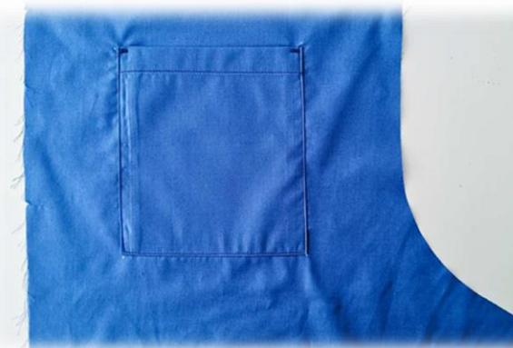
Εικόνα 102. Ραφή της τσέπης στο πίσω μέρος.
