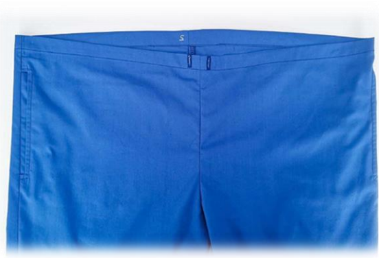
Εικόνα 115. Τοποθέτηση μεγέθους στο κέντρο πίσω.
