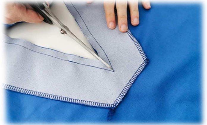
Εικόνα 81. Λιορθώσεις στην λαιμόκοψη για καλύτερη εμφάνιση (ψαλιδιές).
