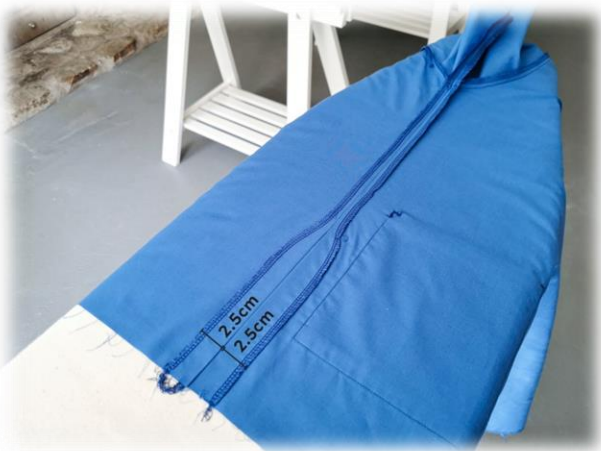
Εικόνα 88. Σιδέρωμα και άνοιγμα των εσωτερικών πλαϊνών ραφών.
