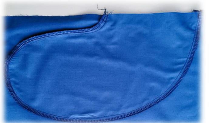
Εικόνα 97. Τοποθέτηση του δευτέρου κομματιού της τσέπης και ένωση με το πρώτο με κολτοράπτη.
