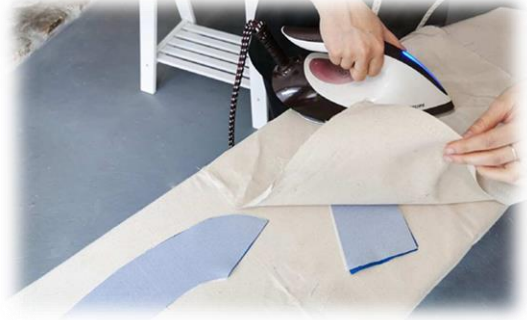
Εικόνα 69. Σιδέρωμα των προηγούμενων κομματιών για την ενεργοποίηση της κόλλας στο ύφασμα ενίσχυσης (αυτοκόλλητο).
