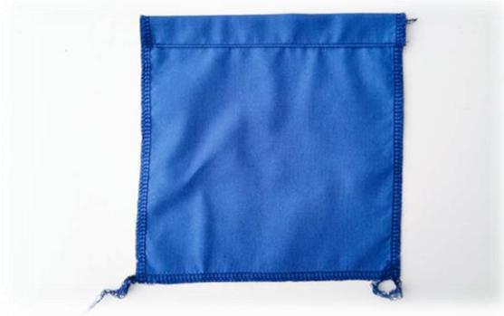
Εικόνα 74. Καθαρίσμα τσέπης και δίπλωμα 2 cm στην ελεύθερη πάνω πλευρά της τσέπης.
