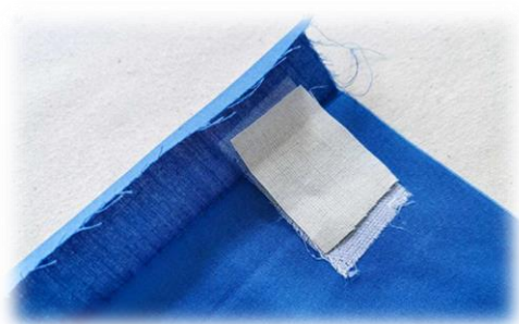
Εικόνα 108. Επιπλέον τοποθέτηση υφάσματος στο σημείο της κουμπότρυπας.
