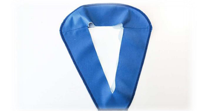
Εικόνα 72. Καθάρισμα της εξωτερικής άκρης της ενισχυμένης λαιμόκοψης με κοπτοράπτη.
