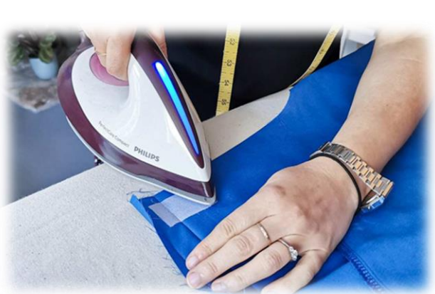
Εικόνα 107. Ενίσχυση στο σημείο της κουμπότρυπας.
