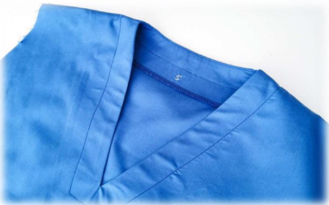
Εικόνα 84. Εξωτερικό γαζί στα 3 cm στη λαιμόκοψη.
