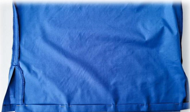
Εικόνα 88. Σιδέρωμα και άνοιγμα των εσωτερικών πλαϊνών ραφών.
