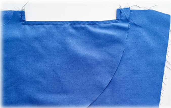
Εικόνα 96. Επιπλέον γαζί στο σημείο του ανοίγματος
