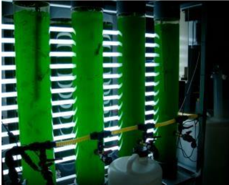
Εικόνα 1.4.3.: Φωτοβιοαντιδραστήρας με τεχνητή πηγή φωτός
