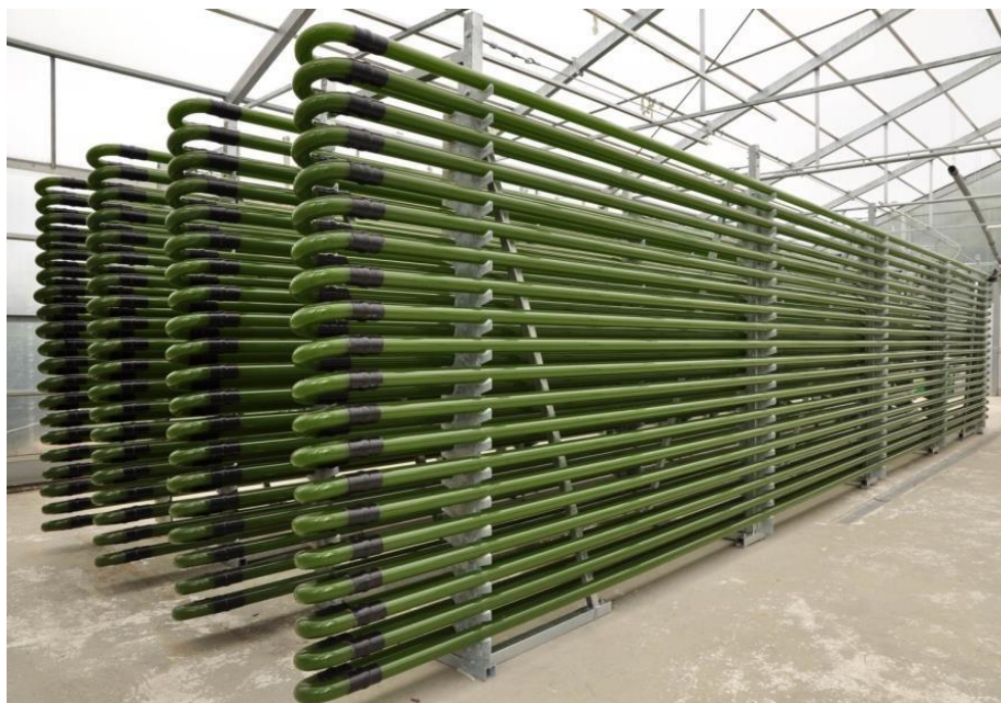
Εικόνα 1.4.5.: Σωληνοειδής PBR ο οποίος κάνει χρήση ηλιακού φωτός.
