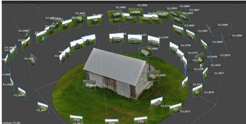
Εικόνα 15: Χρήση φωτογραμμετρίας για την μοντελοποίηση κτίσματος.
