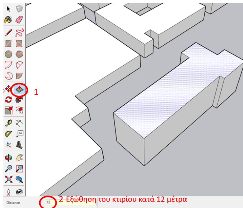
Εικόνα 49: Εξώθηση του κτιρίου του Τμήματος Μηχανικών Πληροφορικής κατά 12 μέτρα με χρήση του εργαλείου “Push/Pull” (Πηγή: Ιδία εργασία).
