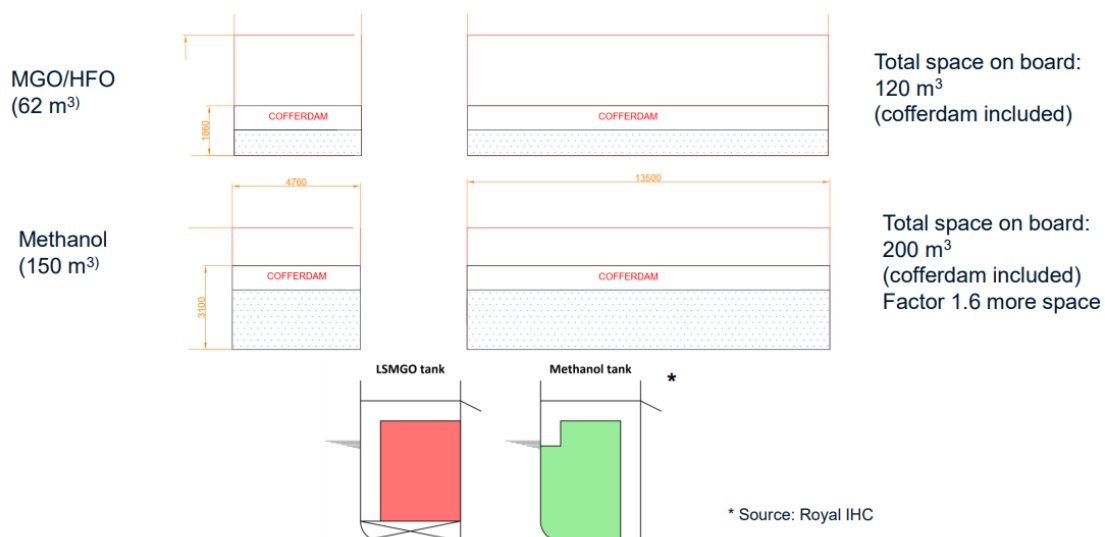
Εικόνα 8. Σύγκριση καταλαμβάνοντος χώρου δεξαμενών (Luomansuu, 2019)
