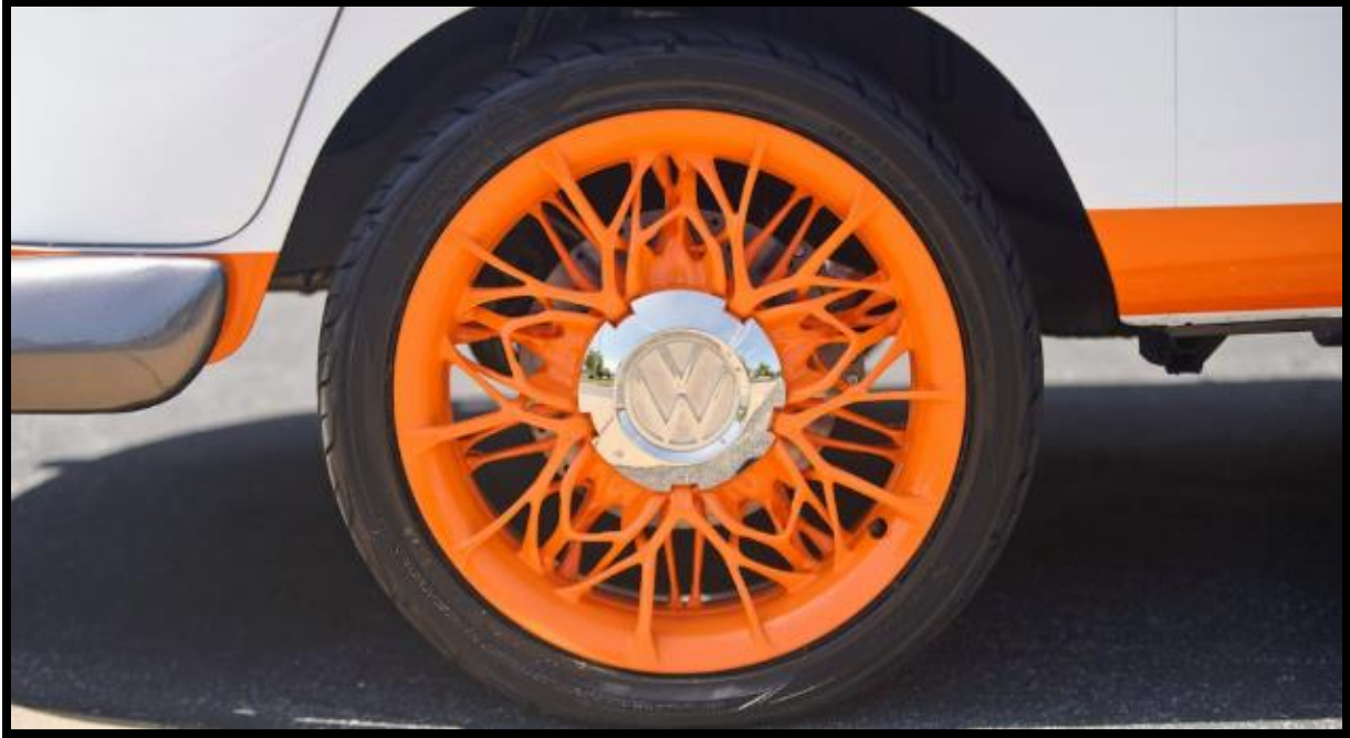
Εικόνα 5: Τροχός VW Microbus 1962, σχεδιασμένος με Generative Design (Deplazes, 2019).
