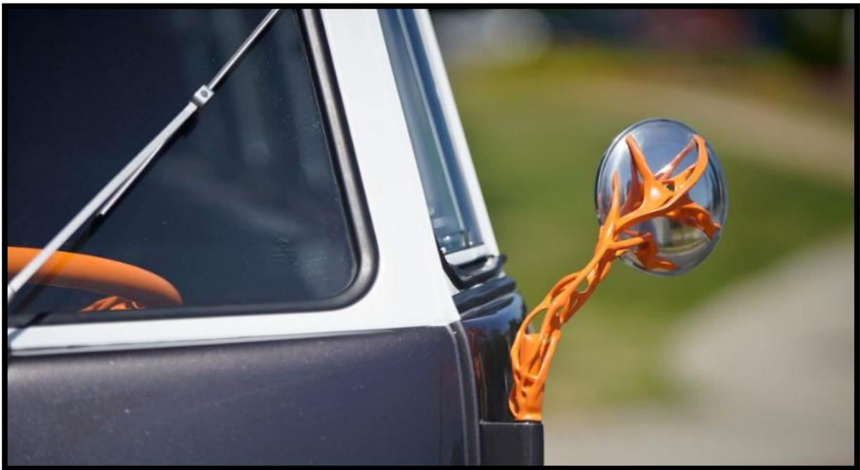
Εικόνα 7: Καθρέφτης VW Microbus 1962, σχεδιασμένος με Generative Design (Deplazes, 2019).
