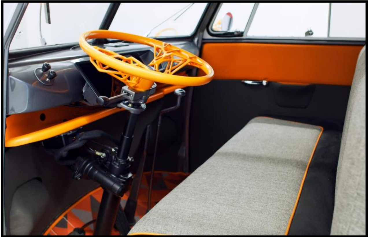
Εικόνα 6: Τιμόνι VW Microbus 1962, σχεδιασμένο με Generative Design (Deplazes, 2019).
