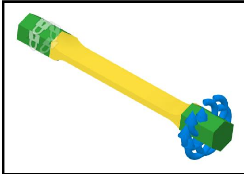
Εικόνα 67: Μοντελοποίηση του δεύτερου δοκιμίου στρέψης για Generative Design.
