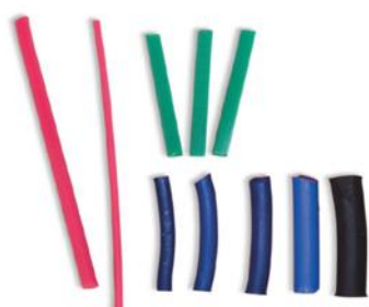
Εικόνα 11: Κέρινοι αγωγοί χύτευσης διαφόρων διατομών. 11
