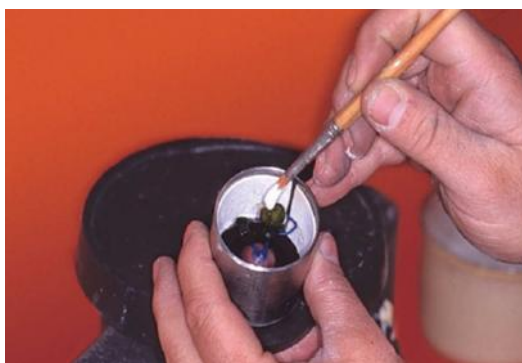
Εικόνα 24: Σταδιακή επένδυση του δακτυλίου με πυρόχωμα. 11
