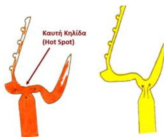
Εικόνα 15: Σχηματική απεικόνιση του φαινομένου “καυτής κηλίδας”. 11
