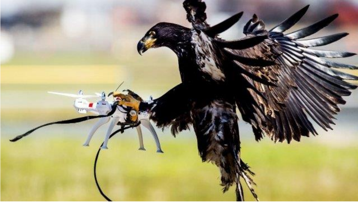
Εικόνα 16 - Χρήση αρπακτικού πτηνού για τη καταστροφή drone
