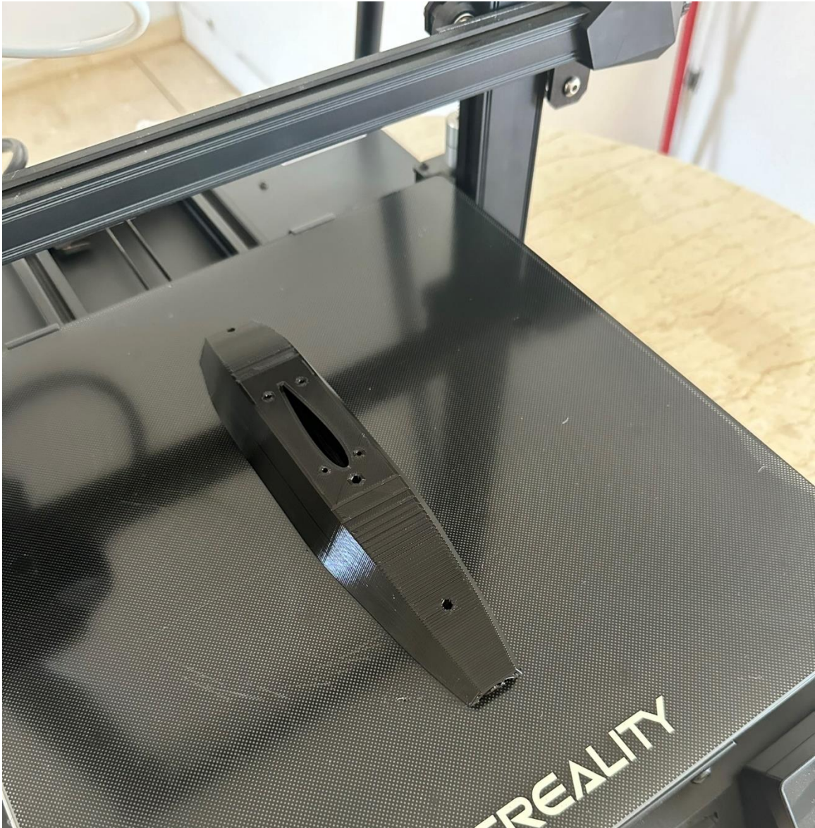
Εικόνα 53 - Ολοκληρωμένη εκτύπωση κάτω μέρος ατράκτου
