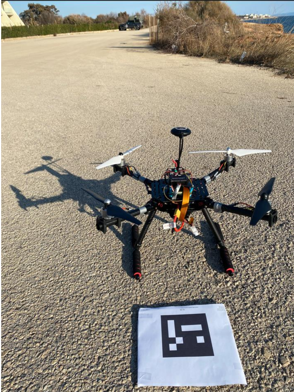
Εικόνα 11 ArUco marker with drone
