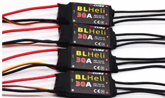
Εικόνα 13 BLHeli 30A ESC
