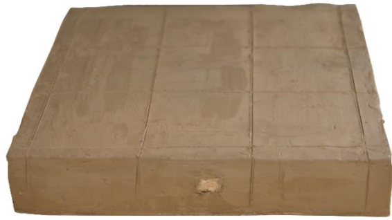
Εικόνα 10: Δεύτερο δοκίμιο, με ξύλινη αρματωσιά και πηλό.
