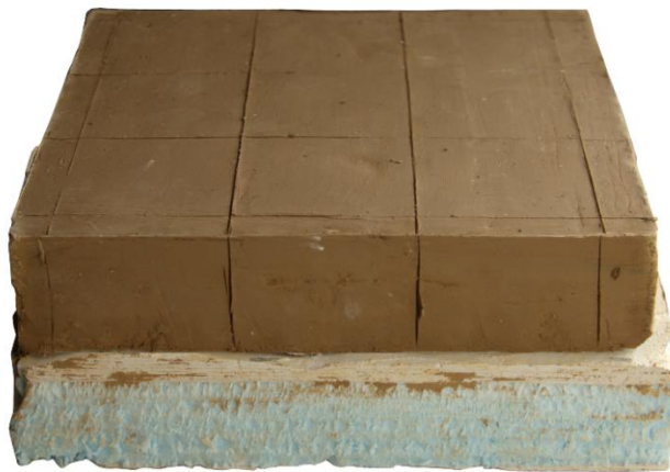
Εικόνα 11: Τρίτο δοκίμιο, με αρματωσιά από DOW. Καρφιά και γύψο (εσωτερικά).
