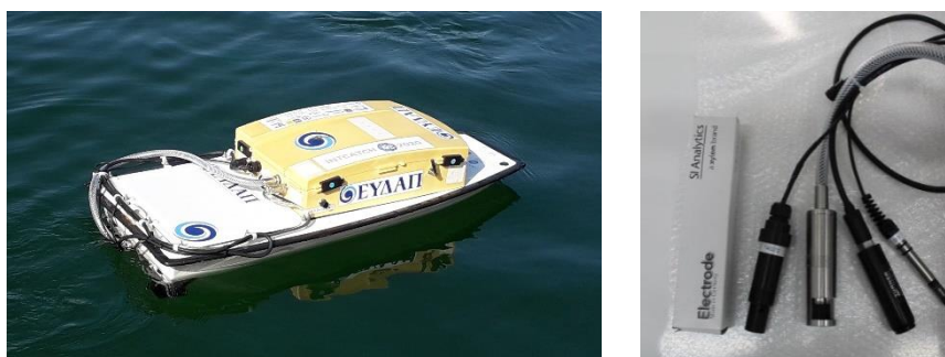
Εικόνα 3.6 Αυτόνομο σκάφος εξοπλισμένο με αισθητήρες pH, EC, ISA, Chl-a και DO (από αριστερά προς δεξιά) [5].
