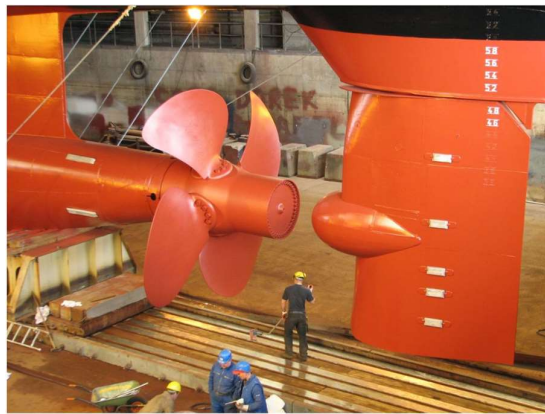
Εικόνα 9: Twisted πηδάλιο με βολβό. (Ferry-rudder-and-propeller, 2007)
