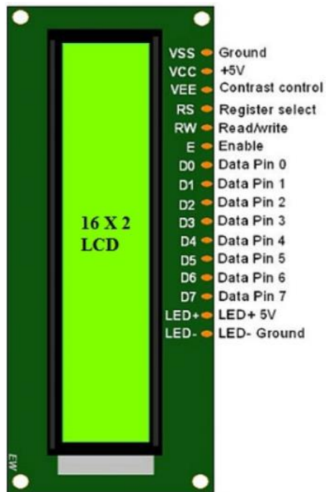
Εικόνα 24 Διάγραμμα οθόνης LCD-16x2
