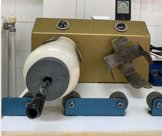
Εικόνα 9 Αναμίκτης εργαστηρίου (Εργαστήριο Επιστήμης & τεχνολογίας Δημητριακών & Προϊόντων τους, Αλίκη Σαρρή 2023)
