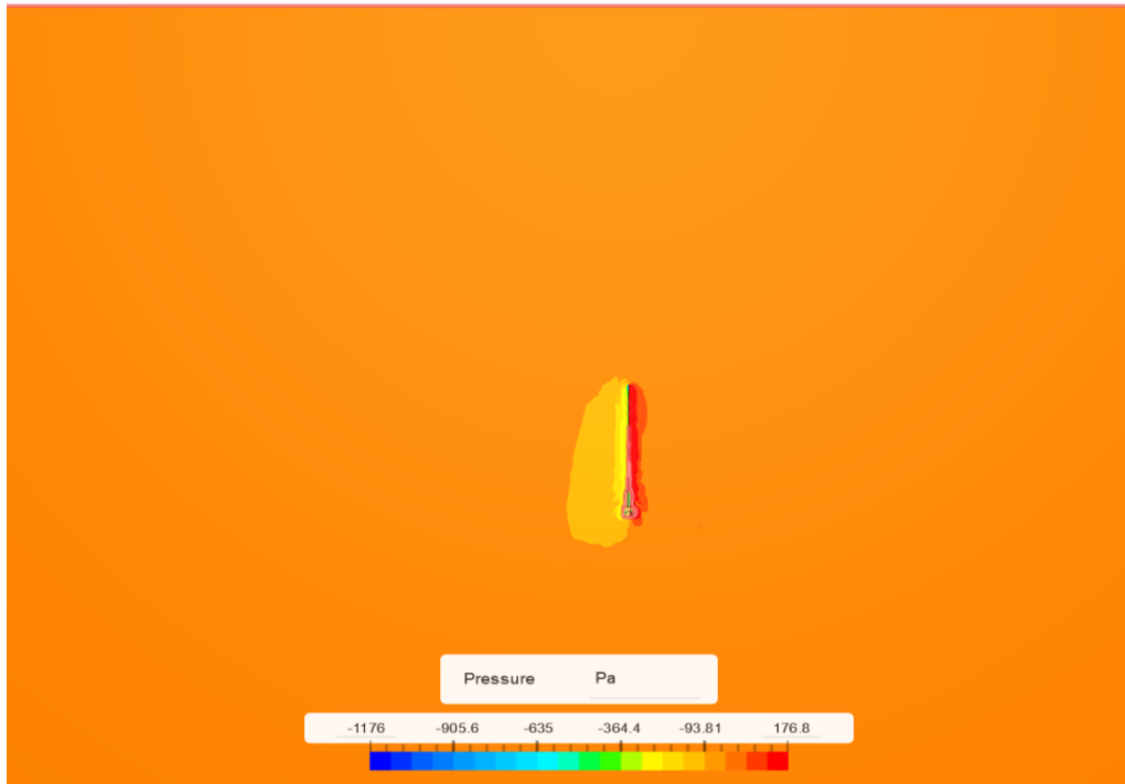
Εικόνα 51 : Contour Πίεσης (πλάγια όψη) από k- \omega μοντέλο, 10 m/s, moderate mesh. (Simscale)
