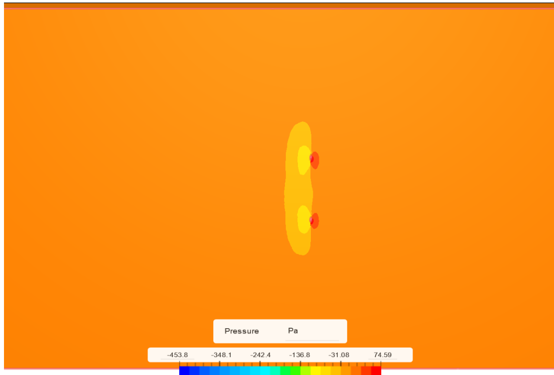
Εικόνα 79 : Contour Πίεσης (άνω όψη) με αραιό πλέγμα (1.200.000 cells), 10m/s αέρα, k- \omega SST μοντέλο. (Simscale)
