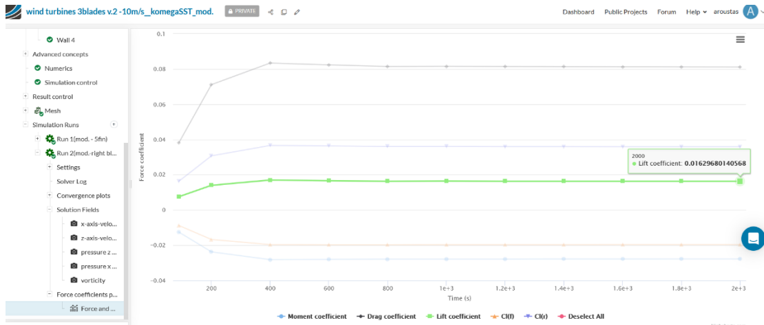
Εικόνα 54 : Convergence plot με highlighted τον συντελεστή άντωσης ( C_l ) του δεξιού πτερυγίου της ανεμογεννήτριας με τη χρήση k-\omega SST μοντέλου. (Simscale)
