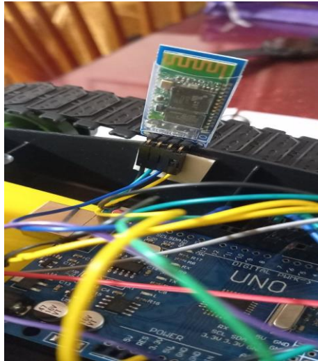
Εικόνα 19: Τοποθέτηση του αισθητήρα Bluetooth HC-05
