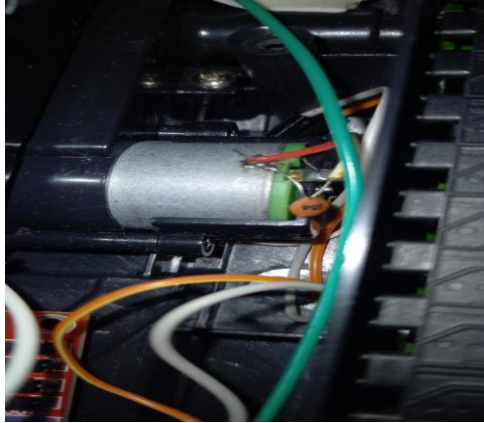
Εικόνα 8: Κινητήρας DC προσαρμοσμένος κατάλληλα στο UGV
