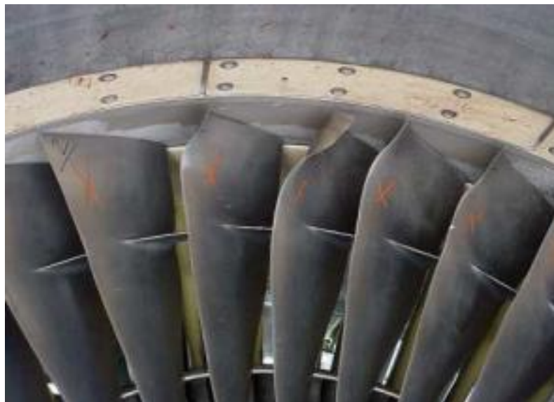
Εικόνα 22: Παραμόρφωση πτερυγίων πρώτης βαθμίδας κινητήρα αεροσκάφους από εισρόφιση ξένου σώματος (FOD)
