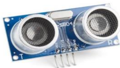
Εικόνα 1 : Υπερηχητικός αισθητήρας για παραγωγή υπερήχων σε κίνηση ανίχνευσης
