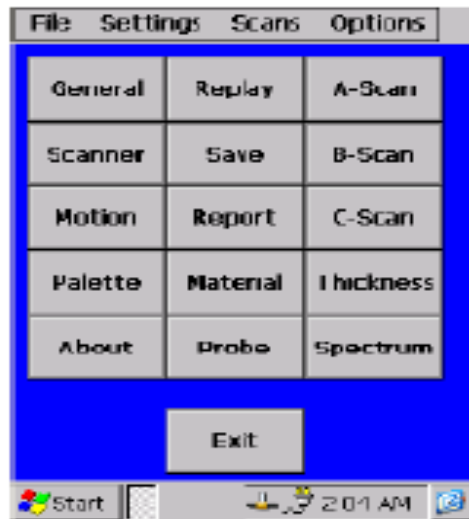
Εικόνα 12.5 Στην Εικόνα απεικονίζεται το Κυρίως παράθυρο Pocket UTwin™ της Συσκευής Υπερήχων UT, Εικόνα από Βασίλειο Μούσα Καθηγητή Πανεπιστημίου Δυτικής Αττικής.
