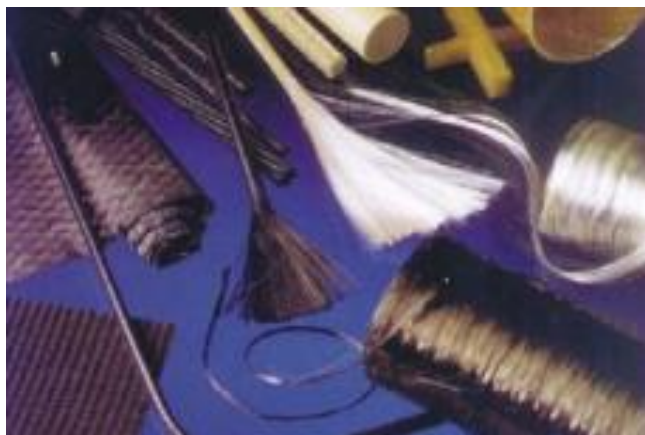
Εικόνα 5.11 Συνήθης Ίνες Άνθρακα και Γυαλιού και Ινοπλισμένα Πολυμερή (FRP), Εικόνα από 13ο Φοιτητικό Συνέδριο Επισκευές Κατασκευών Πάτρα Φεβρουάριος 2017 Ζωσιμά Ελένη-Στρατήγη Βασιλική
