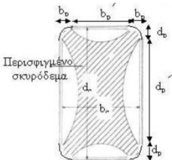
Εικόνα 6.8 Περίσφιγξη με Ινοπλισμένα Πολυμερή και Λάξευση Γωνιών, Εικόνα από Βιβλίο Ενίσχυση Κατασκευών σε Σεισμικά Φορτία Τεχνικό Επιμελητήριο Ελλάδας Αθήνα 2004
