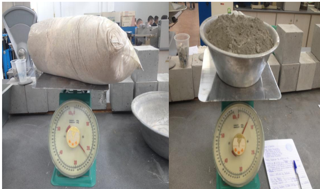
Εικόνα 8.8 Στην Εικόνα απεικονίζεται το ζύγισμα σε ένα σακί άμμου και τσιμέντου για να φτιάξουμε τις αναλογίες στην Παρασκευή των 5 Δοκιμίων που θα το χρησιμοποιήσω στο πείραμα στο εργαστήριο σκυροδέματος του Πανεπιστημίου Δυτικής Αττικής-ΤΕΙ Αθήνας (Γκερδούκη Χριστίνα 21/06/2018).
