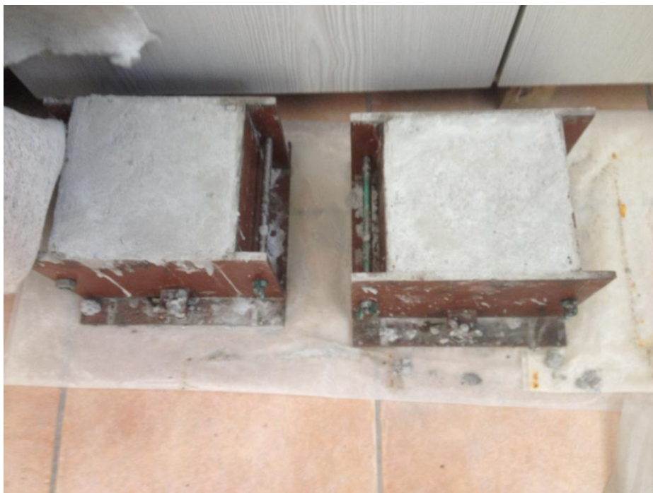
Εικόνα 9.4 Στις εικόνες απεικονίζονται τα δοκίμια στα μεταλλικά καλούπια μετά από περίπου 20 μέρες συντήρησης και το ξεκαλούπωμα τους που θα πρέπει να γίνει στην συνέχεια για την ενίσχυση τους με FRP στο εργαστήριο σκυροδέματος του Πανεπιστημίου Δυτικής Αττικής-ΤΕΙ Αθήνας (Γκερδούκη Χριστίνα 11/07/2018).
