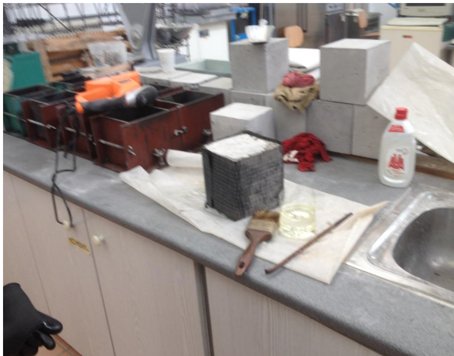
Εικόνα 9.10 Στην Εικόνα απεικονίζονται η Εφαρμογή του μείγματος Εποξειδικής Ρητίνης Δύο Συστατικών SINMAST S2W και το πινέλο όπου χρησιμοποιήσαμε με τύλιγμα του υφάσματος CFRP για την ενίχυση του δοκιμίου στο εργαστήριο σκυροδέματος του Πανεπιστημίου Δυτικής Αττικής-ΤΕΙ Αθήνας (Γκερδούκη Χριστίνα 11/07/2018).
