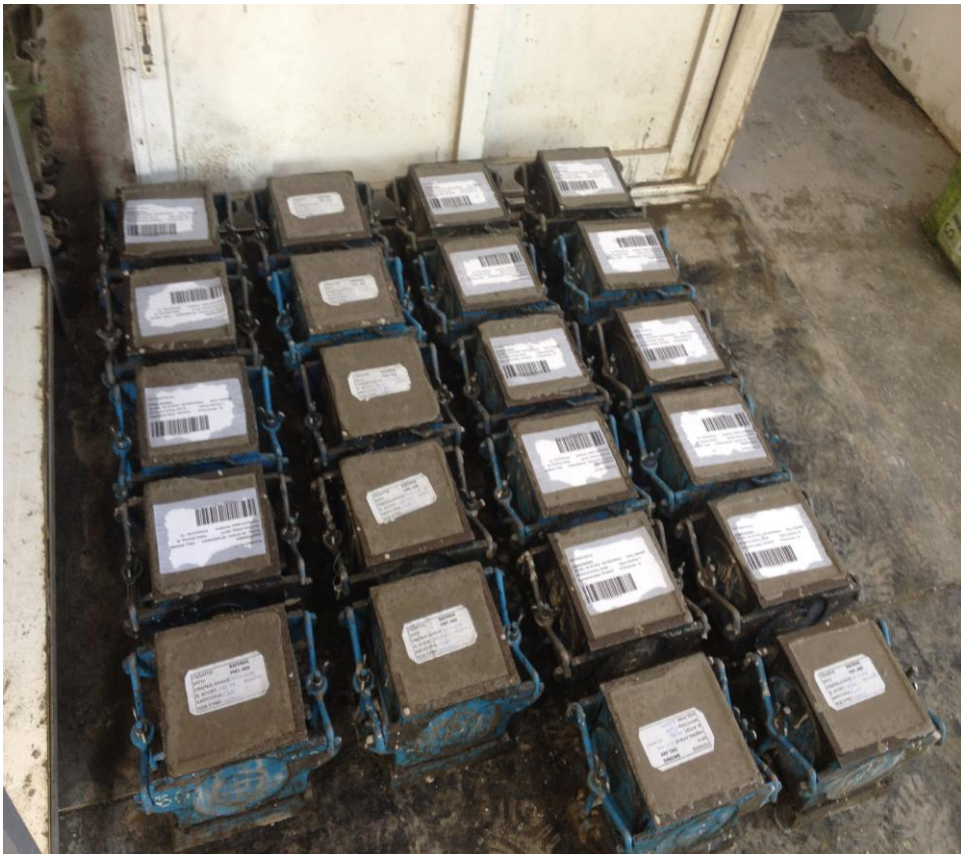
Εικόνα 14.3 Στις Εικόνες απεικονίζονται η Εκπαιδευτική Επίσκεψη στο Εργαστήριο Παραγωγής Σκυροδέματος της INTERMΠΕΤON Α.Ε (Μεταμόρφωση Αττικής ) όπου γίνεται ο Απαραίτητος Έλεγχος στο Τσιμέντο και την τοποθέτηση τους στα Καλούπια 15*15*15 σε ειδικά διαμορφωμένο δωμάτιο για την διατήρηση πριν την Δοκιμή Θλίψης(Γκερδούκη Χριστίνα 14/10/2018).
