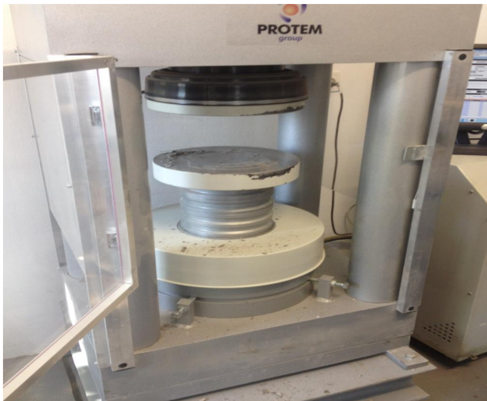
Εικόνα 14.4 Στις Εικόνες απεικονίζονται η Εκπαιδευτική Επίσκεψη στο Εργαστήριο Παραγωγής Σκυροδέματος της INTERMPIETON Α.Ε (Μεταμόρφωση Αττικής ) όπου έχει γίνει ξεκαλούπωμα των Δοκιμίων και την τοποθέτηση τους στο Μηχάνημα Θλίψεως για τον Απαραίτητο Έλεγχο(Γκερδούκη Χριστίνα 14/10/2018).
