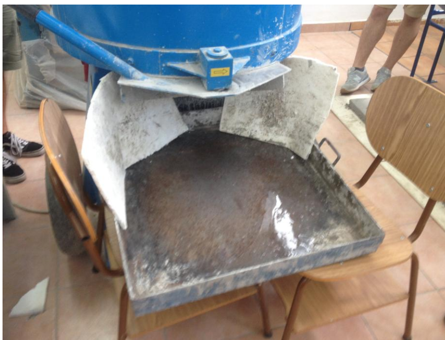
Εικόνα 9.2 Στις εικόνες η συσκευή ανάδευσης και η διαδικασία ανάδευσης των αδρανών υλικών(άμμος,γαρμπίλι,χαλίκια),τσιμέντου και νερού για παραγωγή σκυροδέματος στο εργαστήριο σκυροδέματος του Πανεπιστημίου Δυτικής Αττικής-ΤΕΙ Αθήνας (Γκερδούκη Χριστίνα 21/06/2018).
