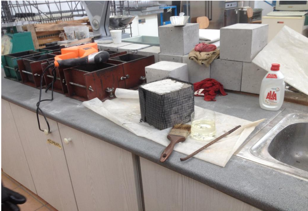
Εικόνα 8.23 Στις εικόνες απεικονίζονται ο δονητής για την Ηλεκτρική Συμπύκνωση του Σκυροδέματος στα Καλούπια Σκυροδέματος, το Σφυρί και το Μυστήρι για την λείανση των Επιφανειών. Επίσης απεικονίζονται το μείγμα ρητινών και το μείγμα στο εργαστήριο σκυροδέματος του Πανεπιστημίου Δυτικής Αττικής-ΤΕΙ Αθήνας (Γκερδούκη Χριστίνα 11/07/2018).
