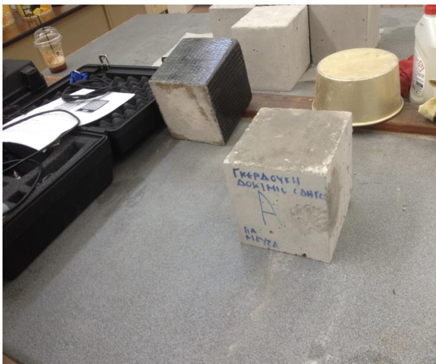
Εικόνα 9.1 Στην εικόνα απεικονίζονται το Απλό Δοκίμιο Σκυροδέτησης με Φελιζόλ που θα χρησιμοποιήσουμε για έλεγχο ρωγμών με την συσκευή UT και το Δοκίμιο Ενισχυμένο με ΙΟΠ στο εργαστήριο σκυροδέματος του Πανεπιστημίου Δυτικής Αττικής-ΤΕΙ Αθήνας (Γκερδούκη Χριστίνα 11/07/2018).
