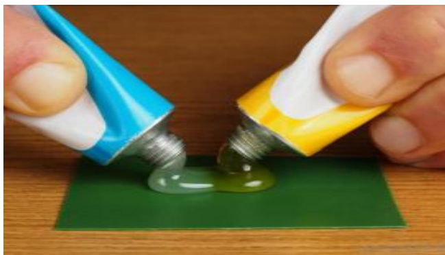
Εικόνα 5.19 Οι εποξικές Ρητίνες θεωρούνται οι καλύτερες μήτρες για χρήση σε ινοπλισμένα πολυμερή λόγω της μεγάλης αντοχής,συγκολλητικής ικανότητας και ανθεκτικότητας, Εικόνα από το 23 ο Φοιτητικό Συνέδριο Επισκευές των Κατασκευών Πάτρα Φεβρουάριος 2017 Κατσαμάκας Αντώνης,Μυλωνάς Αντώνης-Ιωάννης
