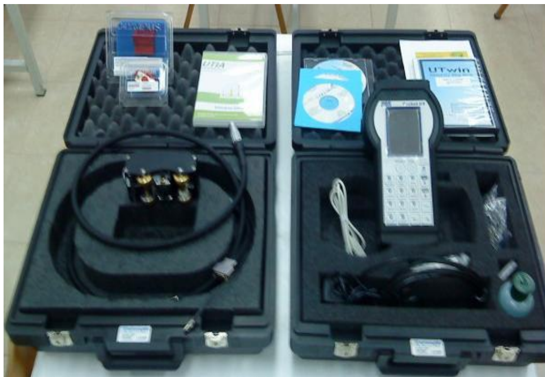
Εικόνα 12.1 Στην Εικόνα απεικονίζεται το Σύστημα Pocket UT με όλα τα απαραίτητα εξαρτήματα που απαιτούνται για τη λειτουργία και την επαναφόρτιση του, συσκευασμένα και τακτοποιημένα σε δυο βαλιτσάκια μεταφοράς όπου θα χρησιμοποιήσουμε για τον Έλεγχο των Δοκιμών του Πειραματικού Μέρους. Εικόνα από Βασίλειο Μούσα Καθηγητή Πανεπιστημίου Δυτικής Αττικής.
