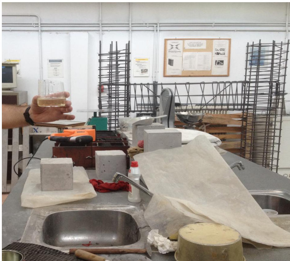
Εικόνα 8.15 Στην εικόνα απεικονίζονται το μίγμα ανάμιξης από τις Ρητίνες SINMAST S2W(1 KG),SINMAST S2WV (1KG) από την Εταιρεία SINTECNO που χρησιμοποιήσαμε στο Πειραματικό Μέρος της Ενίσχυση των Δοκιμών με Μανδύα για το εργαστήριο σκυροδέματος του Πανεπιστημίου Δυτικής Αττικής-ΤΕΙ Αθήνας (Γκερδούκη Χριστίνα 11/07/2018).
