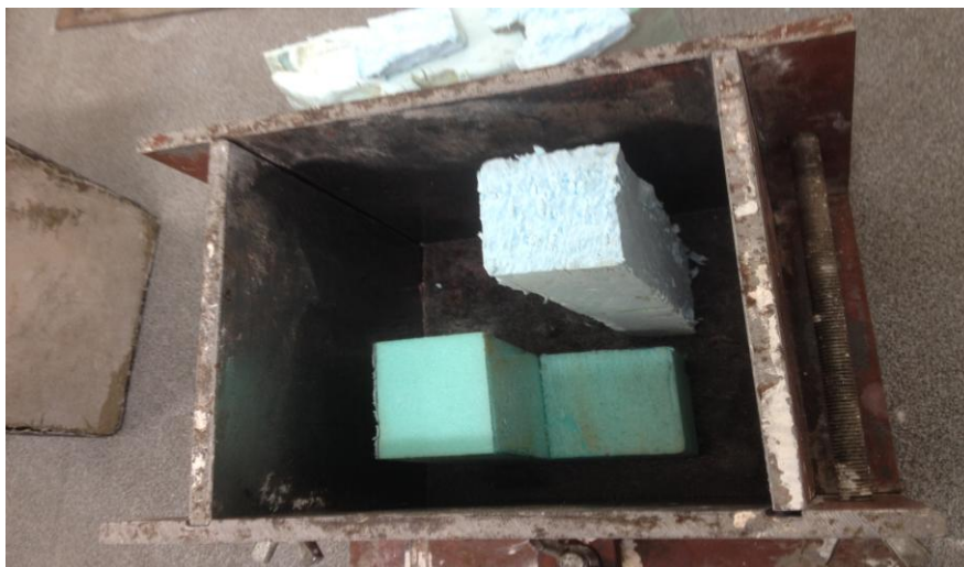
Εικόνα 8.24 Στην εικόνα απεικονίζεται το καλούπι σκυροδέτησης και τα φελιζόλ για την Παρασκευή ενός δοκιμίου ( θα το χρησιμοποιήσουμε για έλεγχο ρωγμών με την συσκευή UT) στο εργαστήριο σκυροδέματος του Πανεπιστημίου Δυτικής Αττικής-ΤΕΙ Αθήνας (Γκερδούκη Χριστίνα 11/07/2018).
