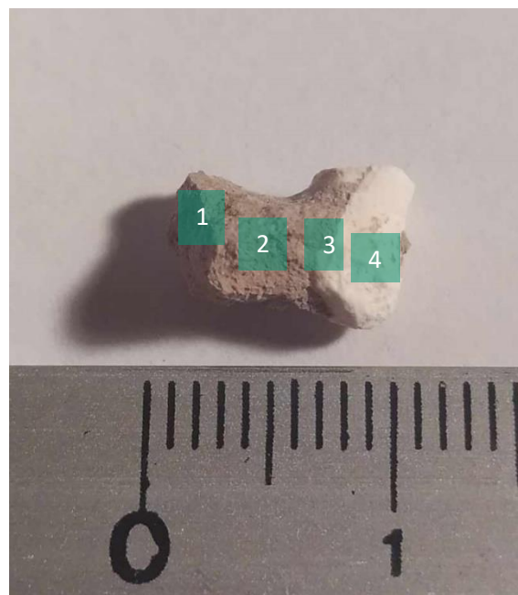
Εικόνα 6: Παράδειγμα δείγματος με τις περιοχές που αναλυθήκαν στο SEM/EDS
