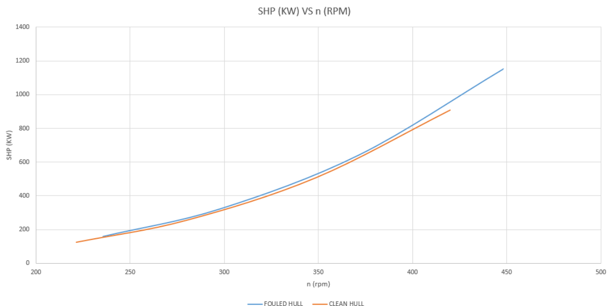
Διάγραμμα 20: Η απαιτούμενη ισχύς πρόωσης συναρτήσει των στροφών για τις περιπτώσεις ρυπασμένης και μη γάστρας μέχρι τη ταχύτητα υπηρεσίας.
