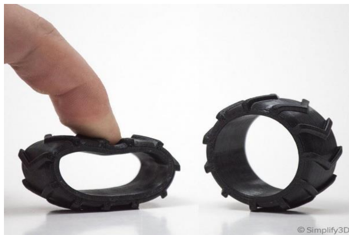
Εικόνα 60 Τεμάχιο κατασκευασμένο από υλικό TPU - Παρατηρούμε το μεγάλο βαθμό ελαστικότητας του υλικού
