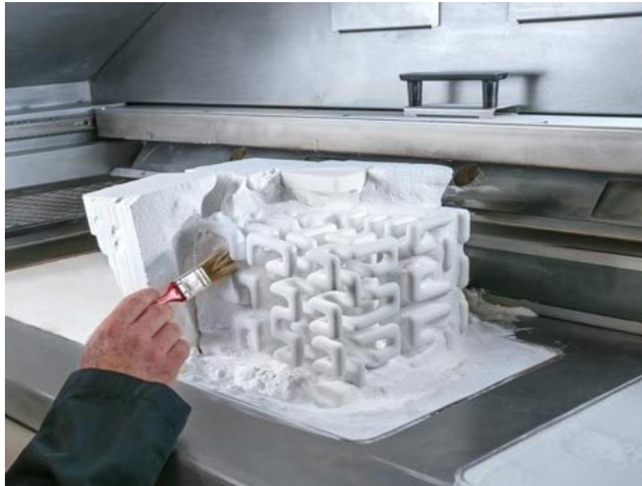
Εικόνα 42 Μετεπεξεργασία εκτυπωμένου τρισδιάστατου αντικείμενου - Science Direct.com
