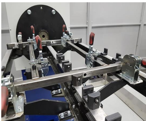
Εικόνα 111 Αυτοματοποιημένο σύστημα συγκράτησης και τοποθέτησης
