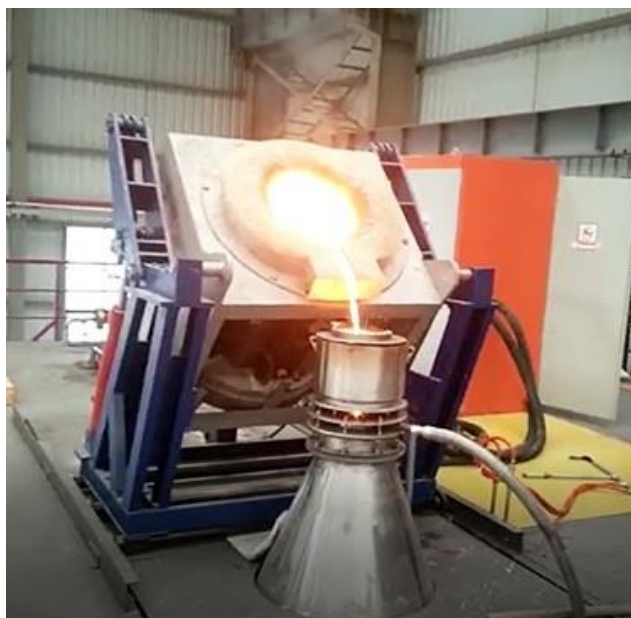
Εικόνα 114 Απεικόνιση απλού συστήματος χύτευσης για αλουμίνιο
