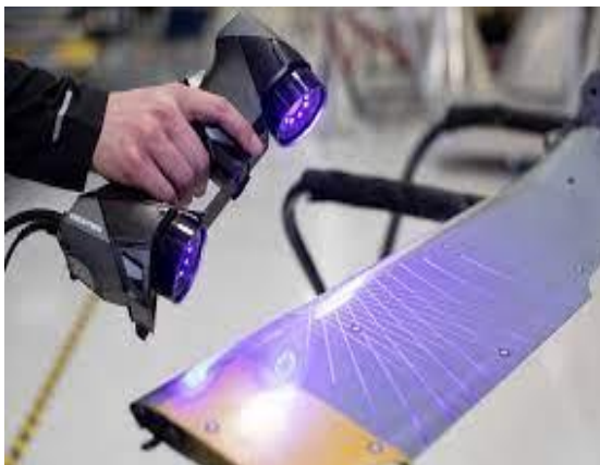
Εικόνα 106 Εφαρμογή Ελέγχου Ποιότητας μέσω Τρισδιάστατου Σαρωτή
