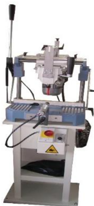
Εικόνα 101 Σύστημα Παντογράφου - Ο μοχλός κατεύθυνσης δημιουργεί τα επιθυμητά σχήματα στην επιφάνεια του προφίλ αλουμινίου
