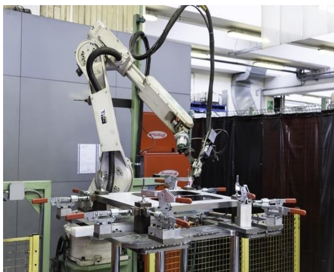
Εικόνα 112 Ρομποτικός Βραχίονας Συγκόλλησης - Παρατηρούμε το συνδυασμό του βραχίονα με το αυτοματοποιημένο σύστημα Συγκράτησης των τεμαχίων - Στο συγκεκριμένο παράδειγμα δεν περιλαμβάνεται τζάμι προστασίας καθώς αποτελεί δική μας προσθήκη
