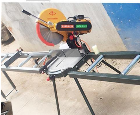
Εικόνα 99 Επιτραπέζιο χειροκίνητο πριόνι - Παρατηρούμε τη ράγα ράουλων (δεξιά - αριστερά) καθώς και το έμβολο πίεσης του προφίλ
