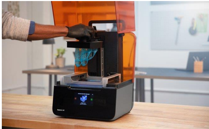
Εικόνα 37 Εκτυπωτής SLA - Η κατεργασία πάντα εκτελείται εντός κλειστού θαλάμου λόγω επικινδυνότητας από απελευθέρωση τοξικών αερίων - Britannica.com
