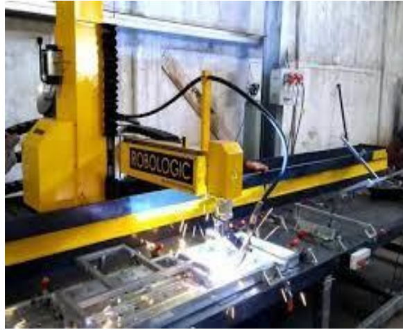
Εικόνα 113 Σύστημα αυτοματοποιημένης Συγκόλλησης με κεφαλή CNC 4 αξόνων
