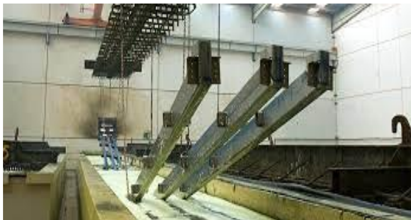
Εικόνα 96 Βύθισμα χάλυβα σε λουτρό Γαλβανοποίησης Science Direct.com
