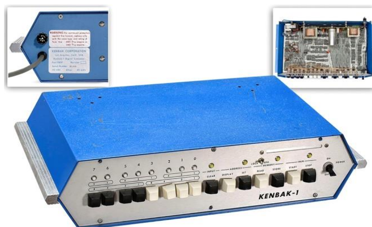
Εικόνα 22 Kenbak-1: Πρώτος Προσωπικός Υπολογιστής - Οι δυνατότητές του περιορίζονταν σε απλές αριθμητικές πράξεις-Science Direct.com
