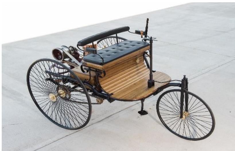
Εικόνα 12 Benz Patent-Motorwagen: Το πρώτο αυτοκινούμενο όχημα με κινητήρα εσωτερικής καύσης - Britannica.com
