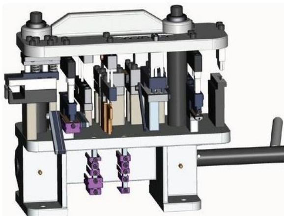
Εικόνα 100 Σύστημα Πρεσών Αλουμινίου - Παρατηρούμε τις πολλαπλές υποδοχές που διαθέτει, καθώς και το μοχλό πίεσης
