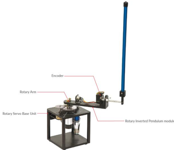
Σχήμα 24: Η διάταξη του περιστροφικού ανάστροφου εκκρεμούς
