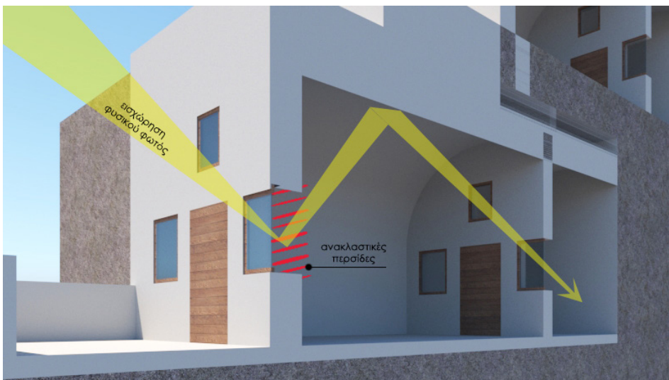
Σχ. 74_ Ένταξη φυσικού φωτός σε μεγαλύτερο βάθος με τη χρήση περσίδων
