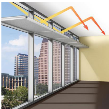
Εικ. 7_ Σχηματική απεικόνιση εγκατάστασης ραφιών φωτισμού
