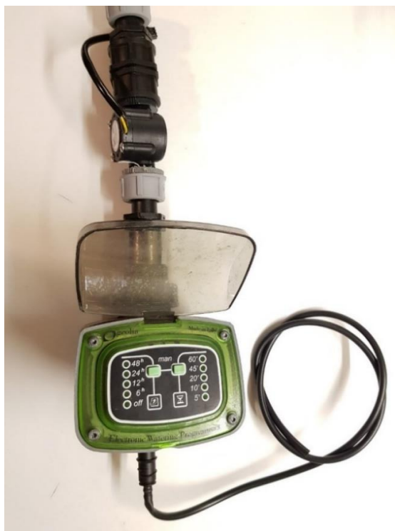
Εικόνα 47 – Σύνδεση αυτόματης βάνας άρδευσης στο κύκλωμα νερού
