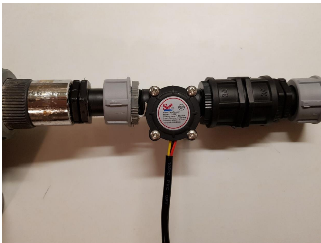
Εικόνα 46 – Σύνδεση αισθητήρα στο κύκλωμα νερού
