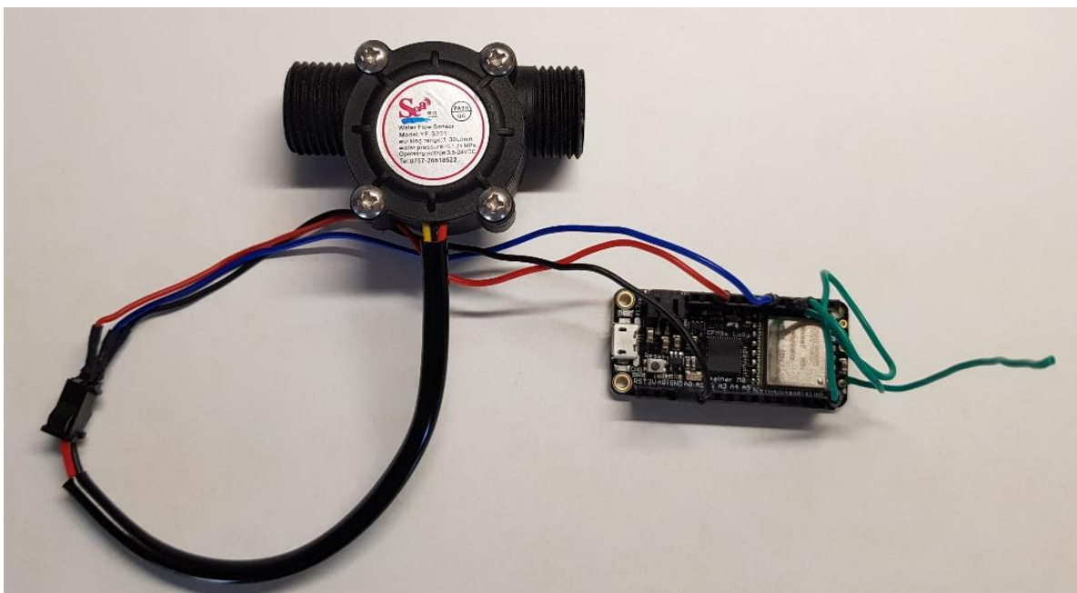
Εικόνα 15 – Η ραδιομονάδα συνδεδεμένη με το αισθητήρα ροής
