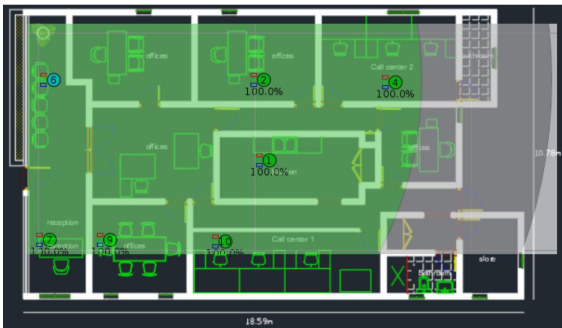
Εικόνα 6.65: Κάτοψη Γραφείου – Πεδίο Radio Environment (UDGM)
