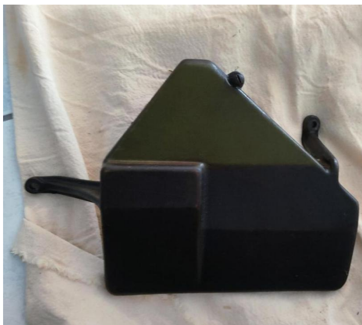
Εικόνα 5.2.6: Στιγμιότυπο από την διαδικασία καθαρισμού που φαίνεται η διαφορά. Φωτογραφία των Ιστορικό Αρχείο ΕΥΔΑΠ-Εργαστήριο Μεταλλικών Αντικειμένων(ΠΑΔΑ), Ροπόκη Άρτεμις-Χαντζιάρα Αρχοντούλα ©
