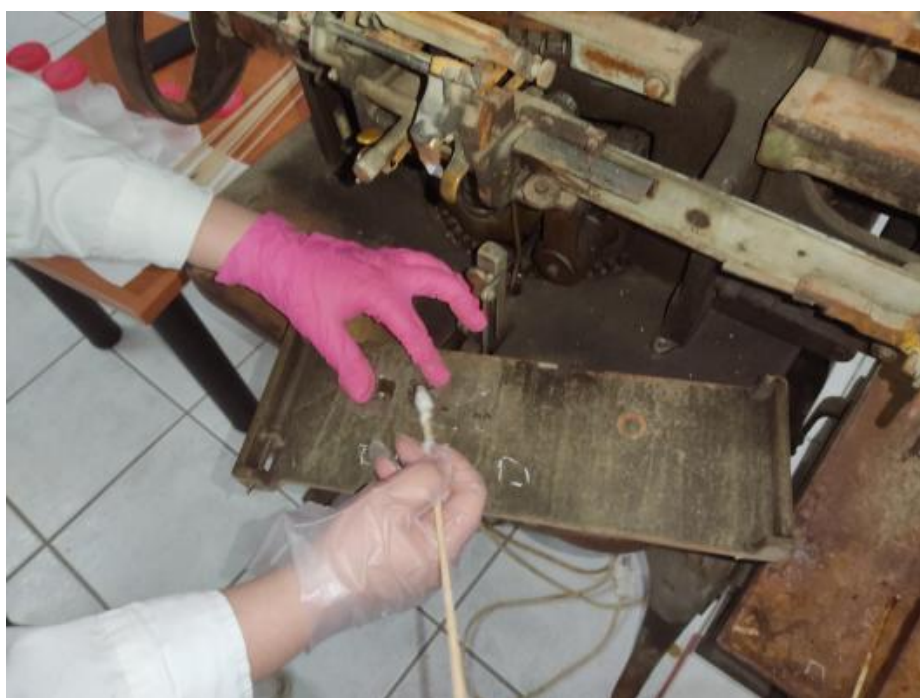
Εικόνα 3.2.7: Στιγμιότυπο από την εφαρμογή των διαλυμάτων, στην μέθοδο των μασκών. Φωτογραφία των Ιστορικό Αρχείο ΕΥΔΑΠ- Εργαστήριο Μεταλλικών Αντικειμένων(ΠΑΔΑ) ,Ροδόκη Άρτεμις- Χαντζιάρα Αρχοντούλα ©
