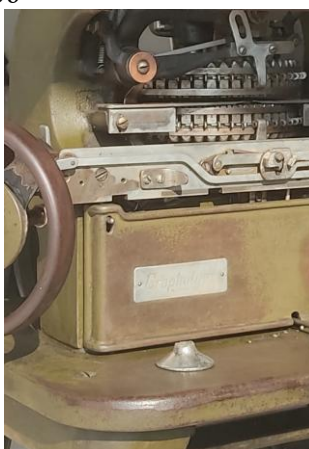
Εικόνα 2.6.2, 2.6.3: Λεπτομέρεια από την απώλεια χρώματος στην επιφάνεια του τραπεζιού. Τα σπασμένα “δόντια” γραναζιού. Φωτογραφία των Ιστορικό Αρχείο ΕΥΔΑΠ-Εργαστήριο Μεταλλικών Αντικειμένων(ΠΑΔΑ), Ροδόκη Άρτεμις- Χαντζιάρα Αρχοντούλα ©
