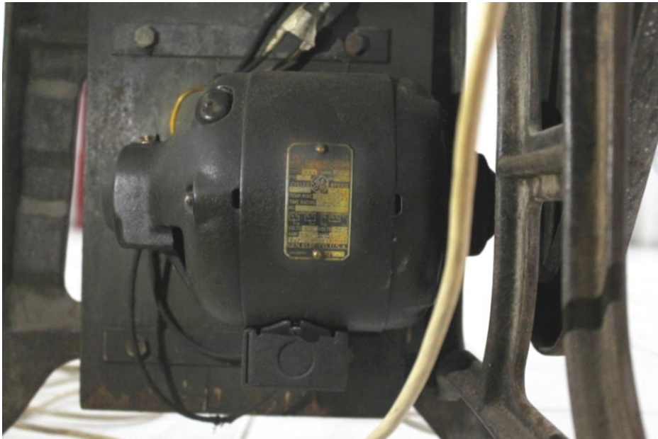
Εικόνα 1.2.1: Η ηλεκτρική μηχανή της εταιρίας GeneralElectric, προσαρτημένη στη Graphotype 6253. Φωτογραφία των Ιστορικό Αρχείο ΕΥΔΑΠ- Εργαστήριο Μεταλλικών Αντικειμένων(ΠΑΔΑ), Ροπόκης Άρτεμις- Χαντζιάρας Αρχοντούλας©
