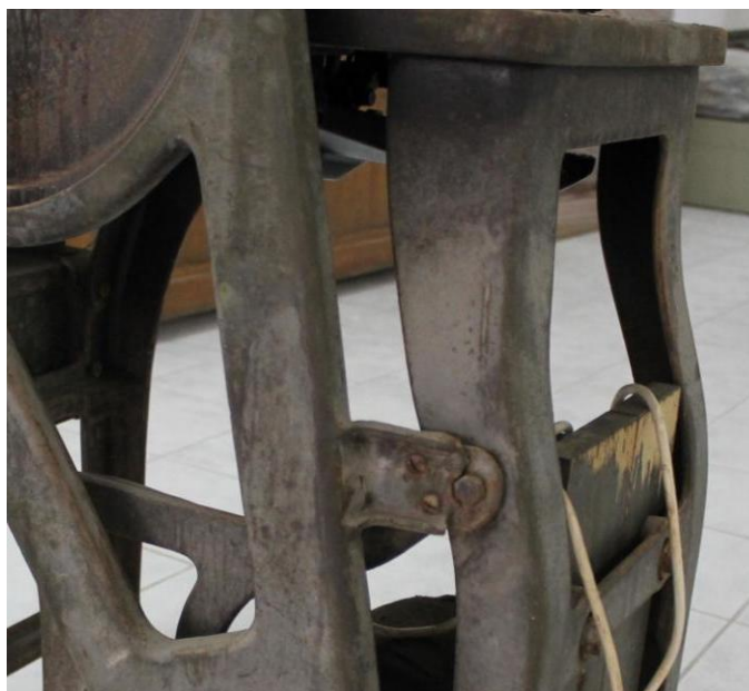
Εικόνα 2.6.1: Λεπτομέρεια από την πίσω όψη του αντικείμενου, που απεικονίζει την απώλεια υλικού και την μεταγενέστερη. Φωτογραφία των Ιστορικό Αρχείο ΕΥΔΑΠ-Εργαστήριο Μεταλλικών Αντικειμένων(ΠΑΔΑ), Ροδόκη Άρτεμις- Χαντζιάρα Αρχοντούλα ©
