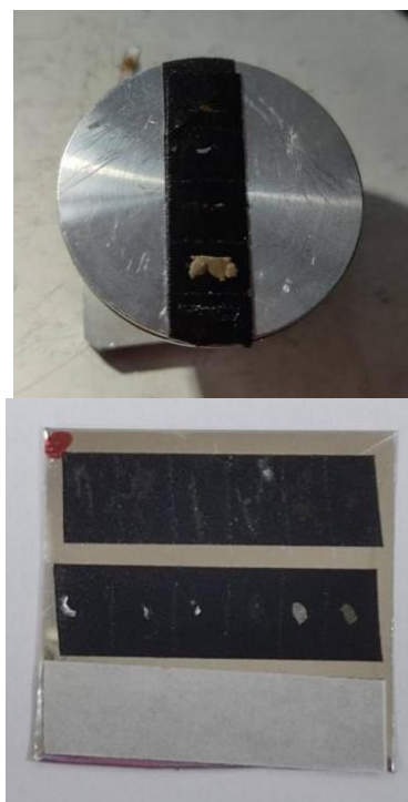
Εικόνα 4.1.1, 4.1.2: Σ Τα δείγματα SEM από την δεύτερη δειγματοληψία. Τα δείγματα από την δεύτερη δειγματοληψία SEM. Φωτογραφίες των Ιστορικό Αρχείο ΕΥΔΑΠ- Εργαστήριο Μεταλλικών Αντικειμένων(ΠΑΔΑ), Ροπέκη Αρτεμης- Χαντζιάρη Αρχοντούλα ©
