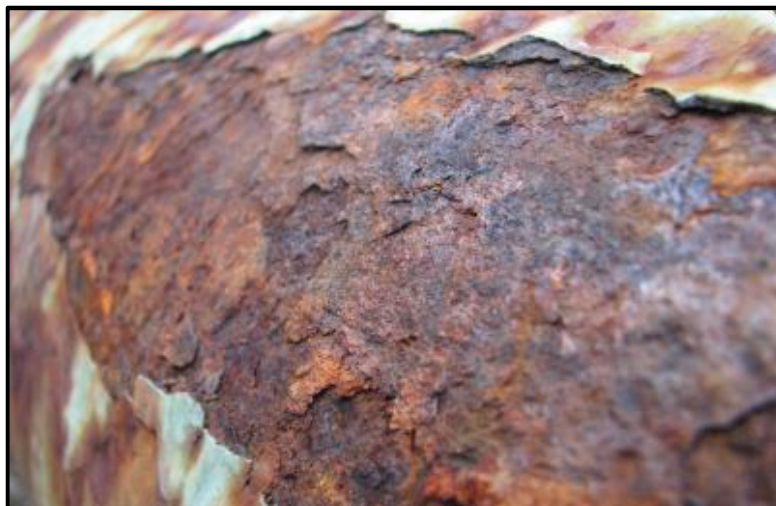
Εικόνα 3.19: Εκτεταμένη διάβρωση λόγω καιρικών φαινομένων (Gopal, 2020)
