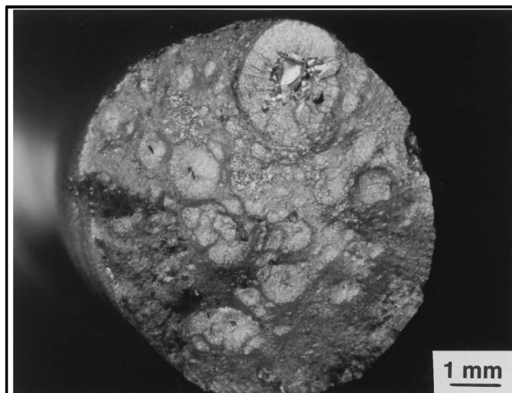
Εικόνα 3.3: Μορφολογία κηλίδων τύπου “μάτι ψαριού” (Whiteley, 2015)
