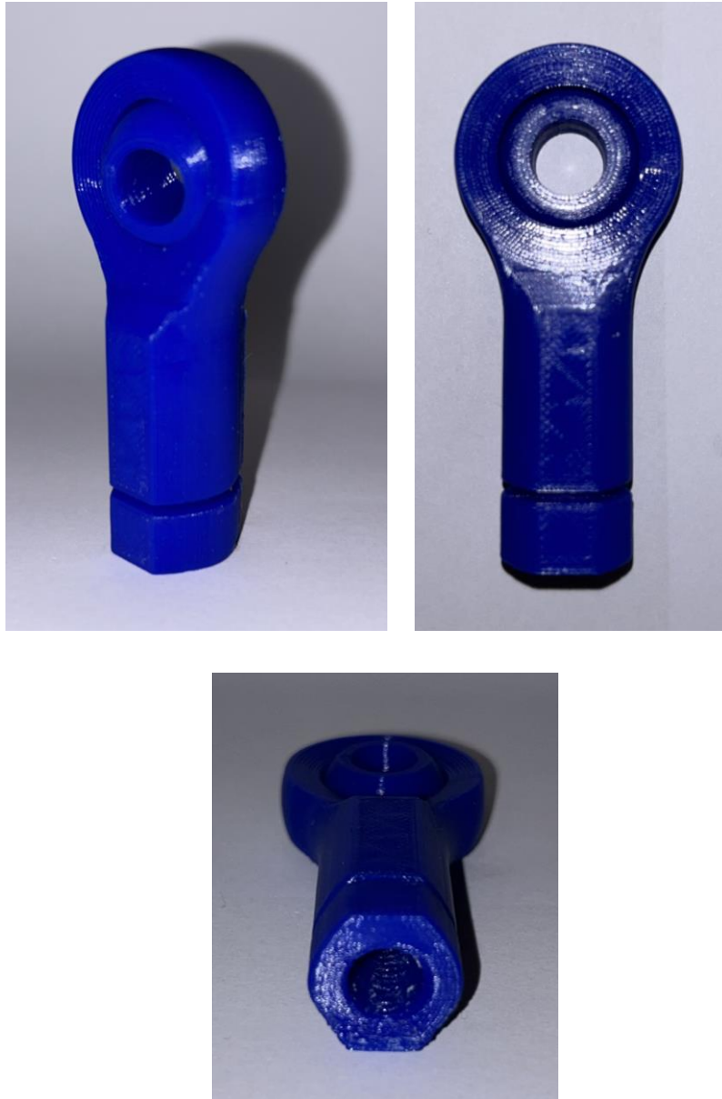
Εικόνα 80: Τελικό 3D εκτυπωμένο πρωτότυπο Rod End Bearing with Female Thread.
