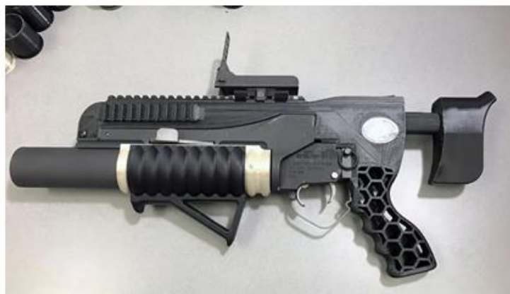
Εικόνα 8: Ο εκτοξευτής χειροβομβίδων RAMBO. Τα 50 ξεχωριστά μέρη που συνθέτουν το RAMBO, εκτός από τα ελατήρια και συνδετήρες, είναι τρισδιάστατα εκτυπωμένα [15].
