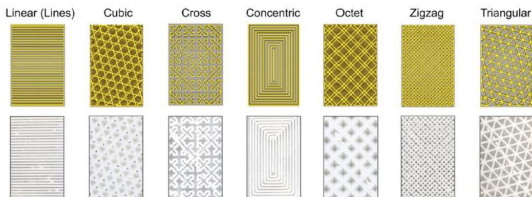
Εικόνα 26: (Πάνω) Διάφορα σχηματικά πλέγματα με μεθόδους σχεδιασμού DfAM και (Κάτω) τυπωμένα δείγματα δοκιμασμένων μοτίβων πλήρωσης [39].
