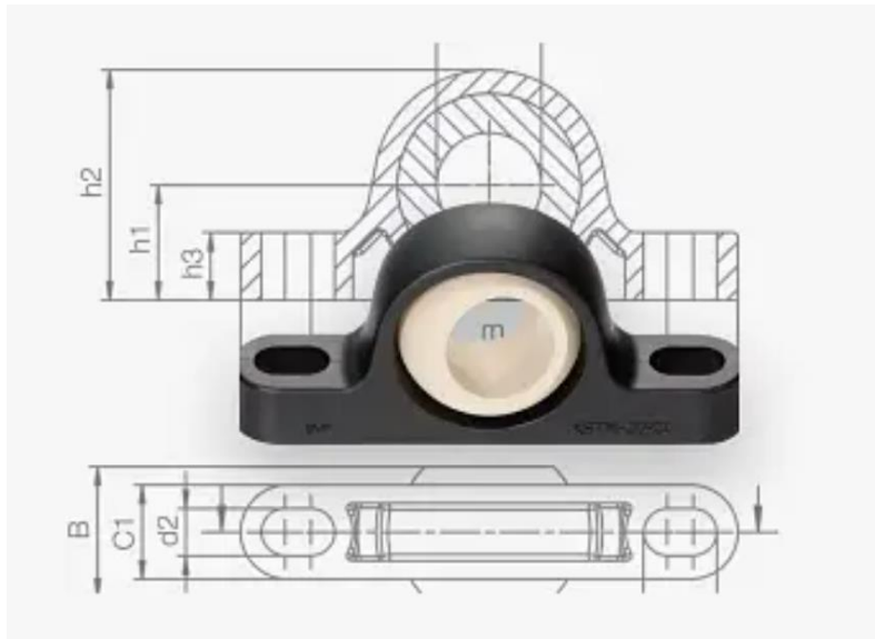
Εικόνα 35: Igubal® Pillow block bearing από σύνθετα υλικά διαθέσιμο στην αγορά [64].
