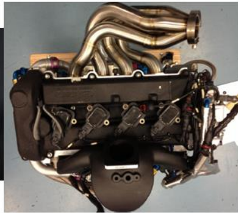
Εικόνα 2: (Αριστερά) Τουρμπίνα αεροπλάνου τρισδιάστατα εκτυπωμένη [7], (Δεξιά) Η μηχανή πολλαπλή εισαγωγής DeltaWing τρισδιάστατα εκτυπωμένη από την CRP USA [8].
