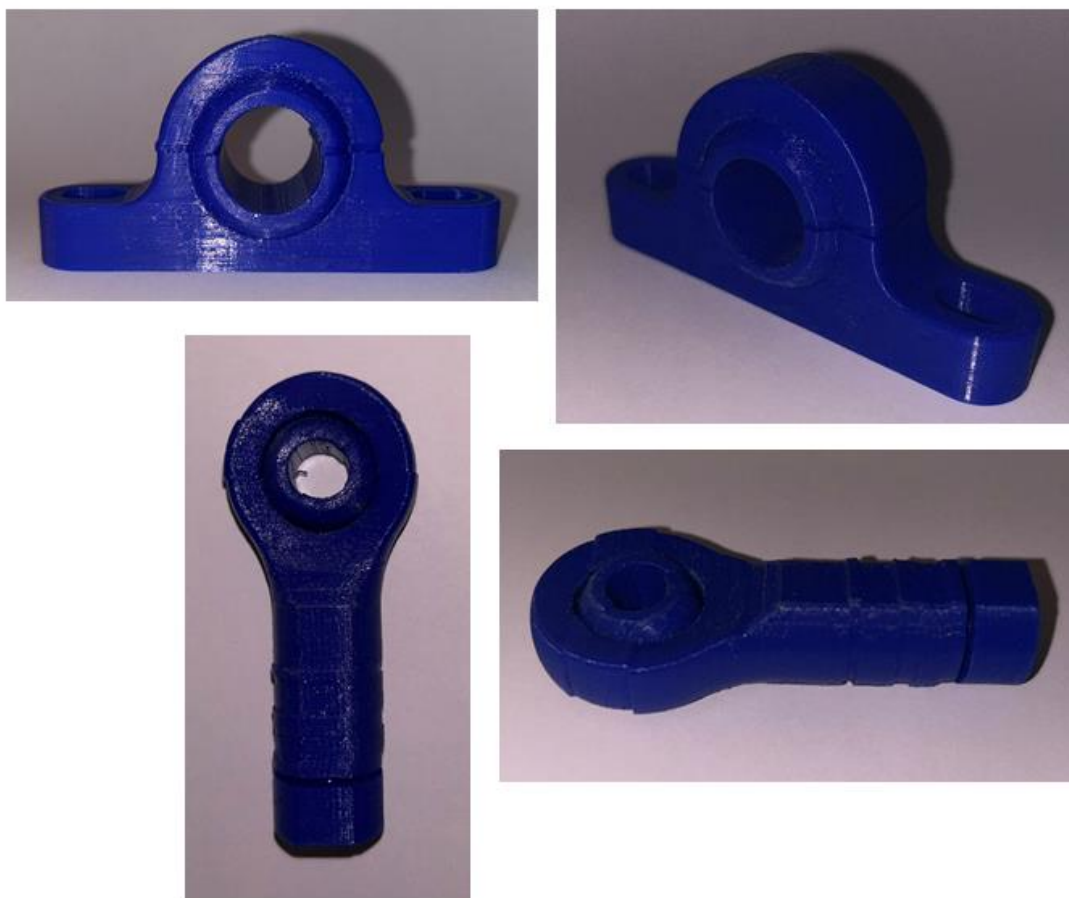
Εικόνα 75: Αστοχίες στις εκτυπώσεις των Pillow Block Bearing with Spherical Ball και Rod End Bearing with Female Thread λόγω μετακίνησης της πλατφόρμας του εκτυπωτή
