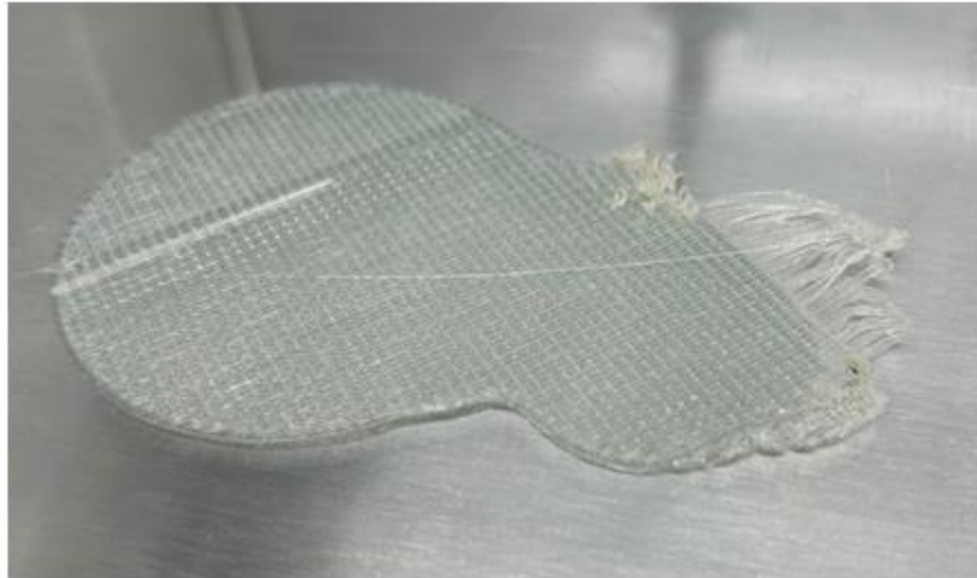
Εικόνα 76: Αστοχία εκτύπωσης της υποστηρικτικής στρώσης του PVA (Raft).
