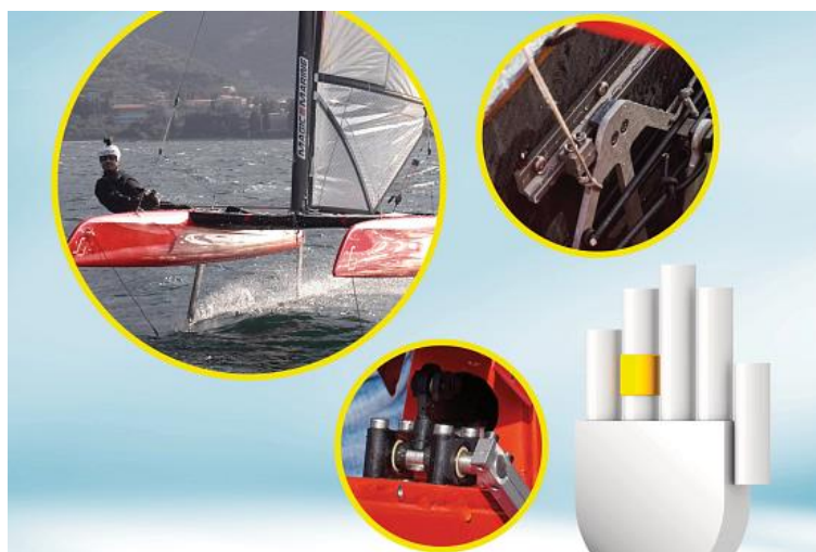
Εικόνα 36: Χρήση πολυμερών εδράνων ολίσθησης της εταιρείας Igus στο αγωνιστικό καταμαράν σκάφος iFLY15 [66].
