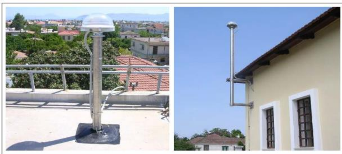
Εικόνα 4.2: Εγκατεστημένες κεραιές σταθμών αναφοράς. Πηγή: (Γιαννίου & Μάστορης, 2007).
