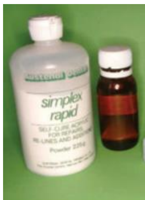
Εικόνα.13: Η αυτοπολυμεριζόμενη ακρυλική ρητίνη. Αποτελείται από δύο υλικά, σκόνη (αριστερά) και υγρό (δεξιά). (Γιαννικάκης, 2018)
