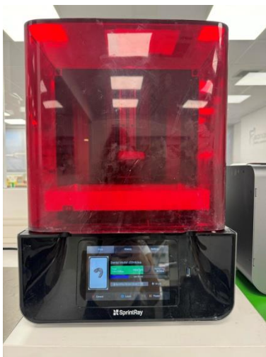
Εικ. 36. Εκτυπωτής DLP τεχνολογίας (SrintRAY pro95S
