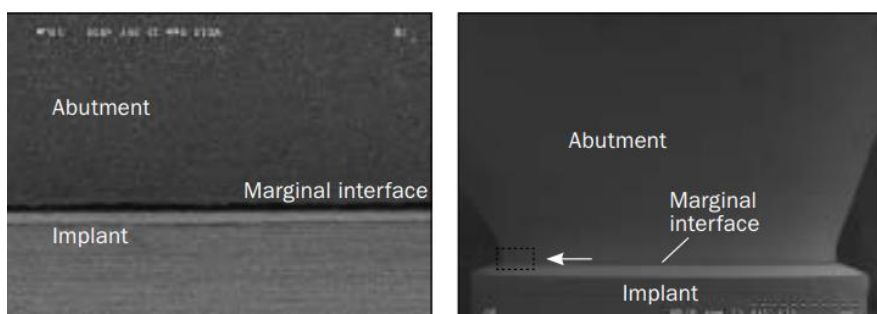
Εικ. 51 Διεπιφάνεια ορίου μεταξύ εμφυτεύματος- στηρίγματος από μια πλευρά. Συνολικά 30 Εικόνες μέσω SEM πάρθηκαν για κάθε πλευρά για κάθε δείγμα, με την κάμερα να λαμβάνει την κάθε Εικόνα σε φορά ρολογιού όπως δείχνει το βέλος. 114
