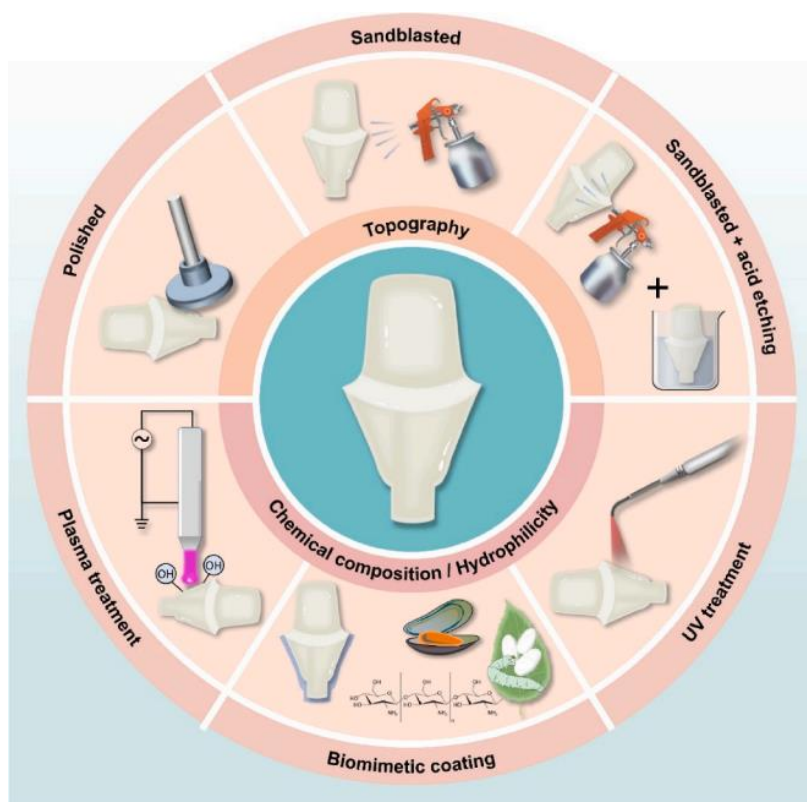
Εικ. 38 Τροποποίηση της επιφάνειας των στηριγμάτων ζirkονίας. 108
