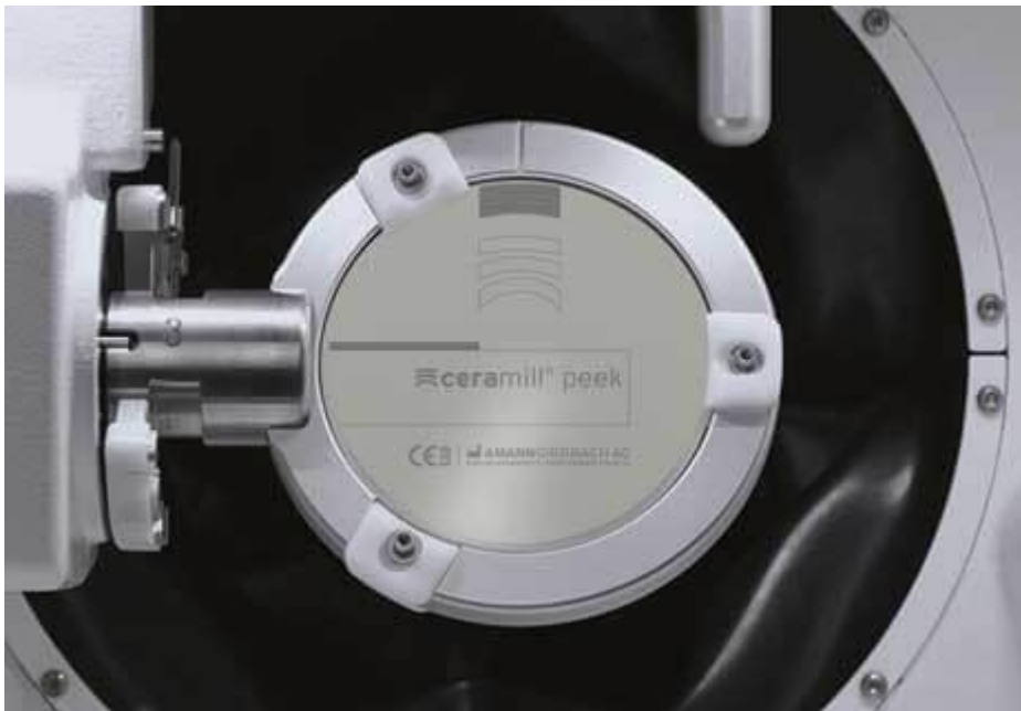
Εικ. 33 Πλάκα κοπής από υλικό PEEK. 26
