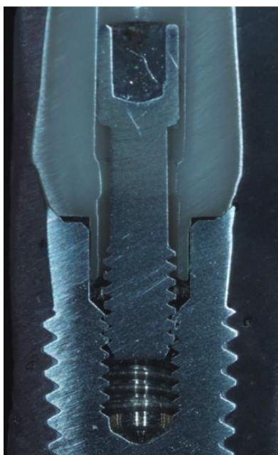
Εικ. 50 Διατομή εξατομικευμένων στηριγμάτων ζirkονίας (Zirkozahn) 148
