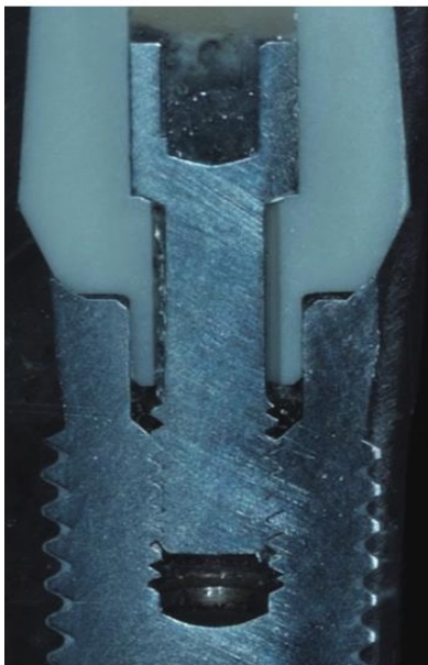
Εικ. 49 Διατομή των προκατασκευασμένων στηριγμάτων ζirkονίας ( ZirAce) 148
