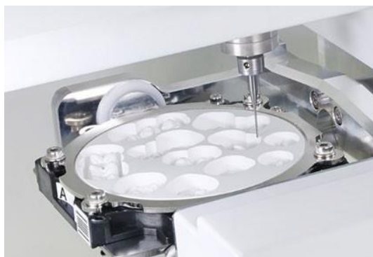
Εικόνα 2: (A) Κοπή μετάλλου (B) Κοπή ζirkονίου
