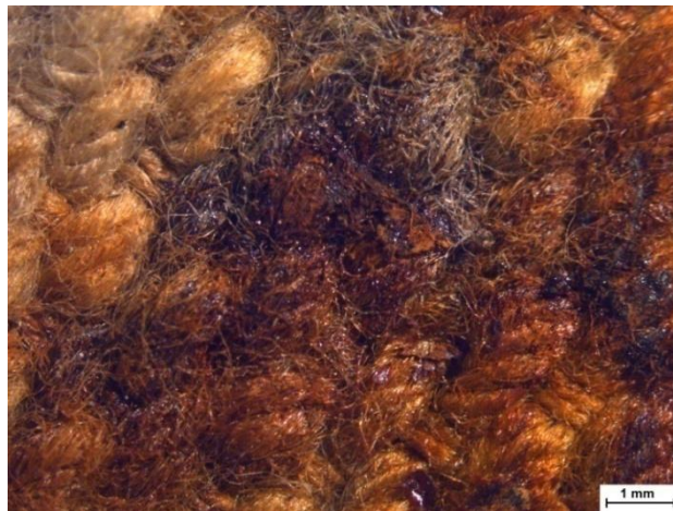
Εικόνα 13: Φωτογραφία από στερεομικροσκόπιο, λεπτομέρεια οξειδίων/υδροξειδίων του σιδήρου ( \text{Fe}^{3+} ).
