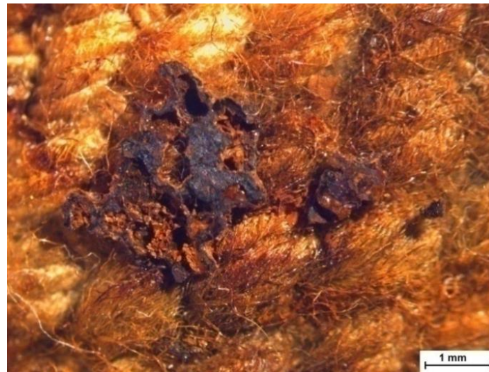
Εικόνα 15: Φωτογραφία από στερεομικροσκόπιο, λεπτομέρεια συσσωματώματος οξειδίων/υδροξειδίων του σιδήρου ( \text{Fe}^{3+} ).
