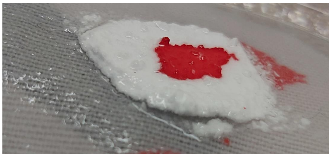
Εικόνα 60: Αποκόλληση του στρώματος κυκλοδεκανίου από το υπόστρωμα.
