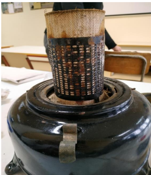
Εικόνα 39: Το φιτίλι που έρχεται σε επαφή με τον ορειχάλκινο κύλινδρο της δεξαμενής.
