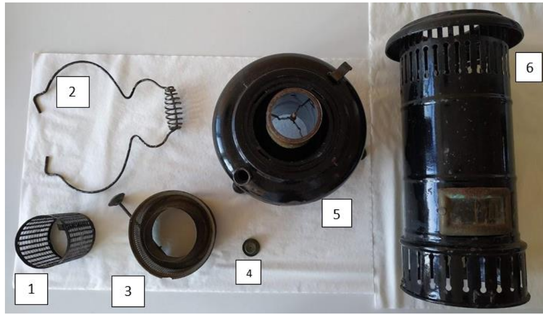
Εικόνα 3: Τα επιμέρους τμήματα του θερμαντικού σώματος διαχωρισμένα. Από αριστερά προς τα δεξιά, (1) ο μεταλλικός φορέας του φιτιλιού, (2) η χειρολαβή, (3) το εξάρτημα ανύψωσης, (4) το ορειχάλκινο πώμα της δεξαμενής, (5) η δεξαμενή και (6) η καμινάδα.
