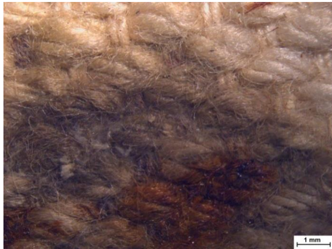
Εικόνα 17: Φωτογραφία από στερεομικροσκόπιο, λεπτομέρεια μαύρου λεκέ και οξειδίων/υδροξειδίων του σιδήρου.
