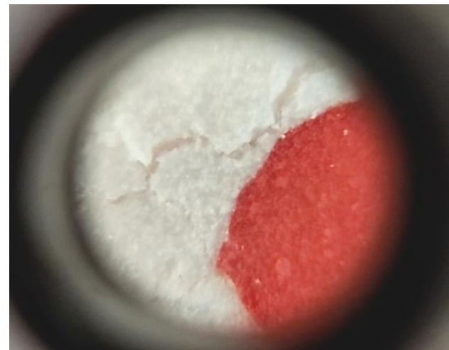
Εικόνα 56: Κατάσταση του μονωτικού στρώματος μετά από μία ώρα.
