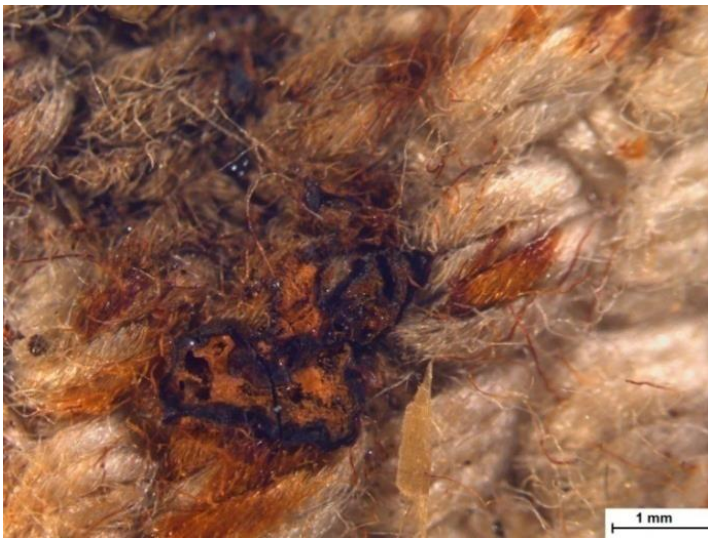
Εικόνα 16: Φωτογραφία από στερεομικροσκόπιο, λεπτομέρεια συσσωματώματος οξειδίων/υδροξειδίων του σιδήρου ( \text{Fe}^{3+} ).
