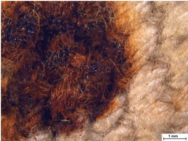
Εικόνα 14: Φωτογραφία από στερεομικροσκόπιο, λεπτομέρεια οξειδίων/υδροξειδίων του σιδήρου ( \text{Fe}^{3+} ).
