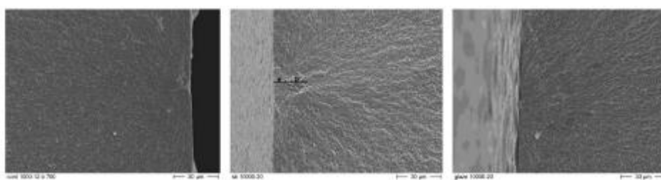
Εικόνα 40. Εικόνες επιφανειών θραύσης. Από αριστερά προς τα δεξιά: ομάδα ελέγχου, αεροτριβής και γυαλισμένες. 26
