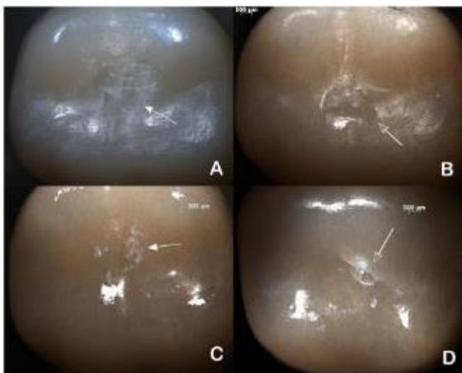
Εικόνα 26. Μασητική όψη επιφανειακής βλάβης μετά από 2 εκατομμύρια κύκλους (0,8x). Μικρές (A) και μεγάλες (C) φθοράς στις στεφάνες RNC. Φθορές (C) και ρωγμές (D) στις στεφάνες LD μετά από 2 εκατομμύρια κύκλους. 37
