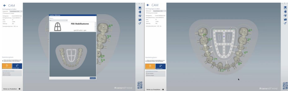
Εικόνα B19: Τοποθέτηση σταθεροποιητή (Γεωργούλης 2024)
