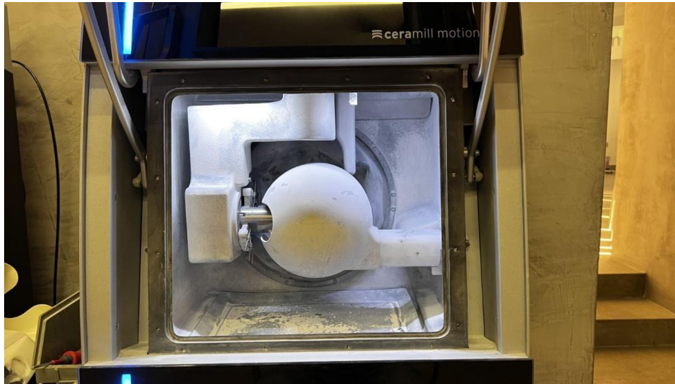
Εικ. B10: Κοπτικό μηχάνημα CNC(Amann Girrbach, Αυστρία) με ανοιχτό τον θάλαμο. Παρατηρείται ότι η βάση της πλάκας καλύπτεται από ένα πλαστικό, με σκοπό να διατηρηθεί ο θάλαμος κοπής καθαρός. (Γεωργούλης 2024)
