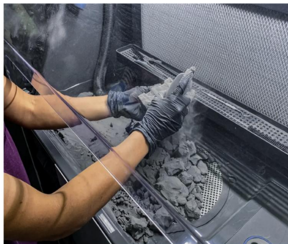
Εικόνα Β31: Αφαίρεση του εκτυπωμένου αντικείμενου από την βάση εκτύπωσης και ο καθαρισμός του (Γεωργούλης 2024)
