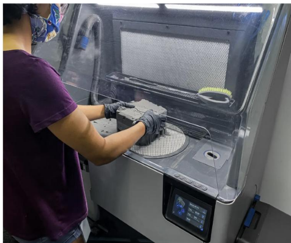
Εικόνα Β31: Αφαίρεση του εκτυπωμένου αντικείμενου από την βάση εκτύπωσης και ο καθαρισμός του (Γεωργούλης 2024)
