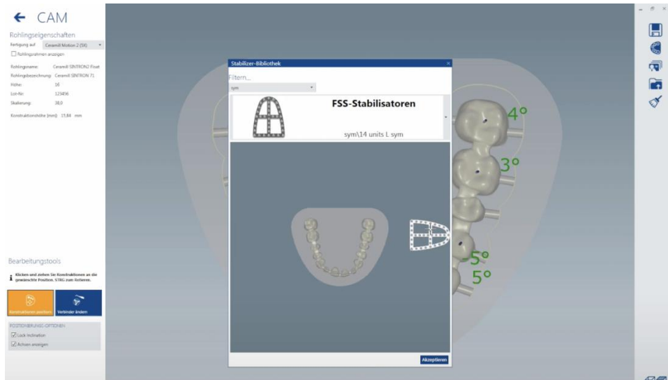
Εικόνα B18: Τοποθέτηση σταθεροποιητή (Γεωργούλης 2024)
