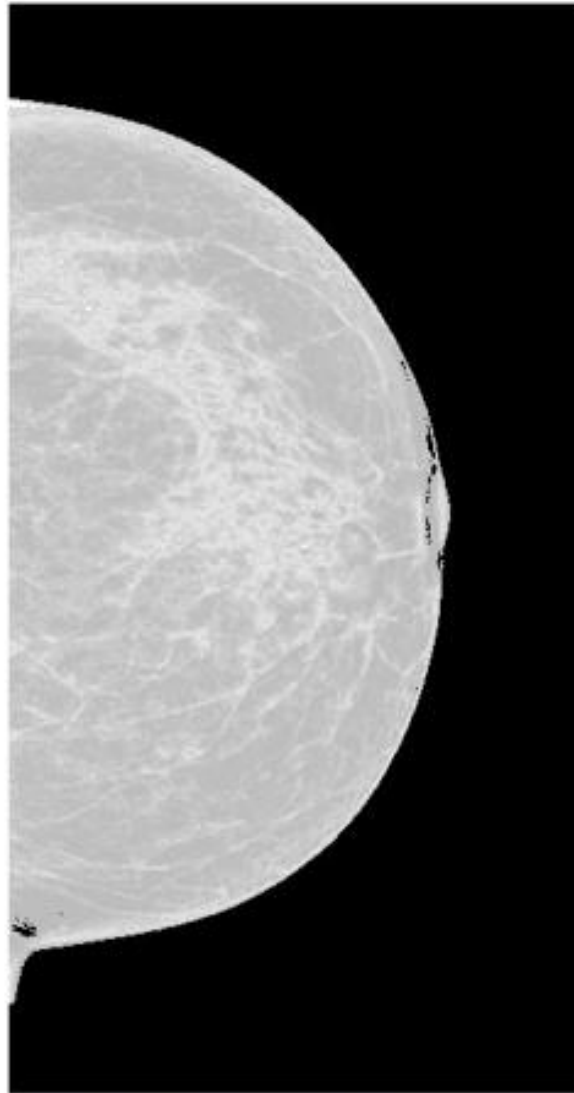
Εικόνα 4.36: Αποτέλεσμα ακτινοβολήσης του ομοιώματος της Εικόνας 2.4.2 με ενέργεια δέσμης 32keV και πάχος μαστού 5,5cm.
