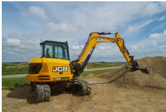
Εικόνα 4.1 , Μηχάνημα εκσκαφέα , Πηγή : https://easyplanthire.com/blog/what-are-the-different-types-of-excavators/
