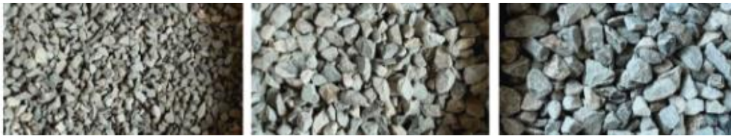
Εικόνα 2.6 Φυσικά αδρανή σκυροδέματος Πηγή: https://www.hindawi.com/journals/ace/2020/8821048/fig1/
