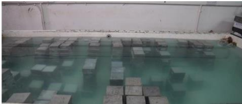
Εικόνα 4.11 Εμποτισμός δοκιμίων στο νερό για τον καθορισμένο χρόνο σκλήρυνσης
