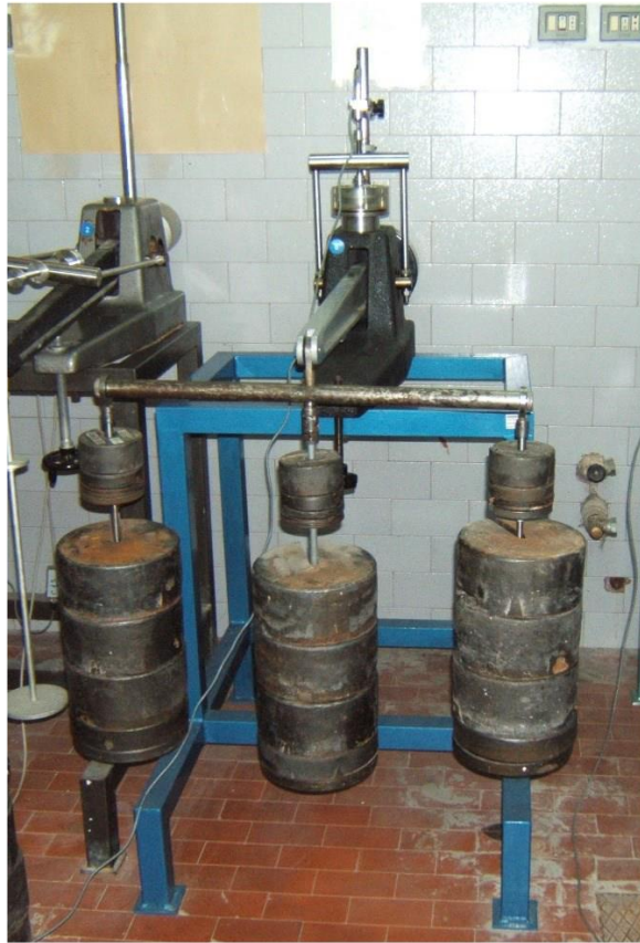
Σχήμα 11.22 Τροποποιημένη συσκευή οιδημέτρου του Politecnico di Bari (Guglielmi, 2017).
