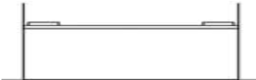
Σχήμα 2 : Δεξαμενή Πλωτής Οροφής
