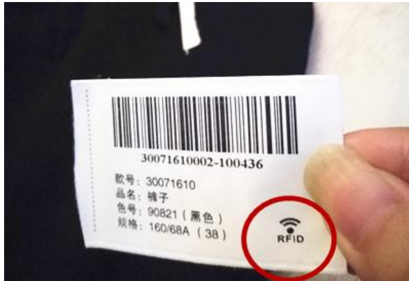
Εικόνα 8: Ετικέτα ενδύματος με ενσωματωμένο σύστημα RFID
