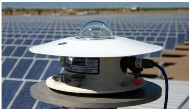
Εικόνα 4.5: Αισθητήρας πυρανόμετρου για μέτρηση της ηλιακής ακτινοβολίας
