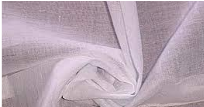
Εικόνα 16 : Ύφασμα από βαμβάκι με ενσωμάτωση διοξειδίου του τιτανίου. ( https://www.asianscientist.com/tag/hubei-university/ )
