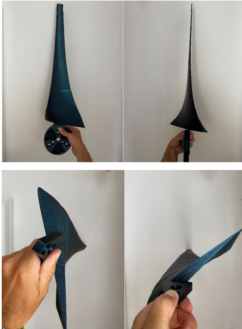
Εικόνα 6.4: Εκτυπωμένο πτερύγιο και βάση στήριξης.
