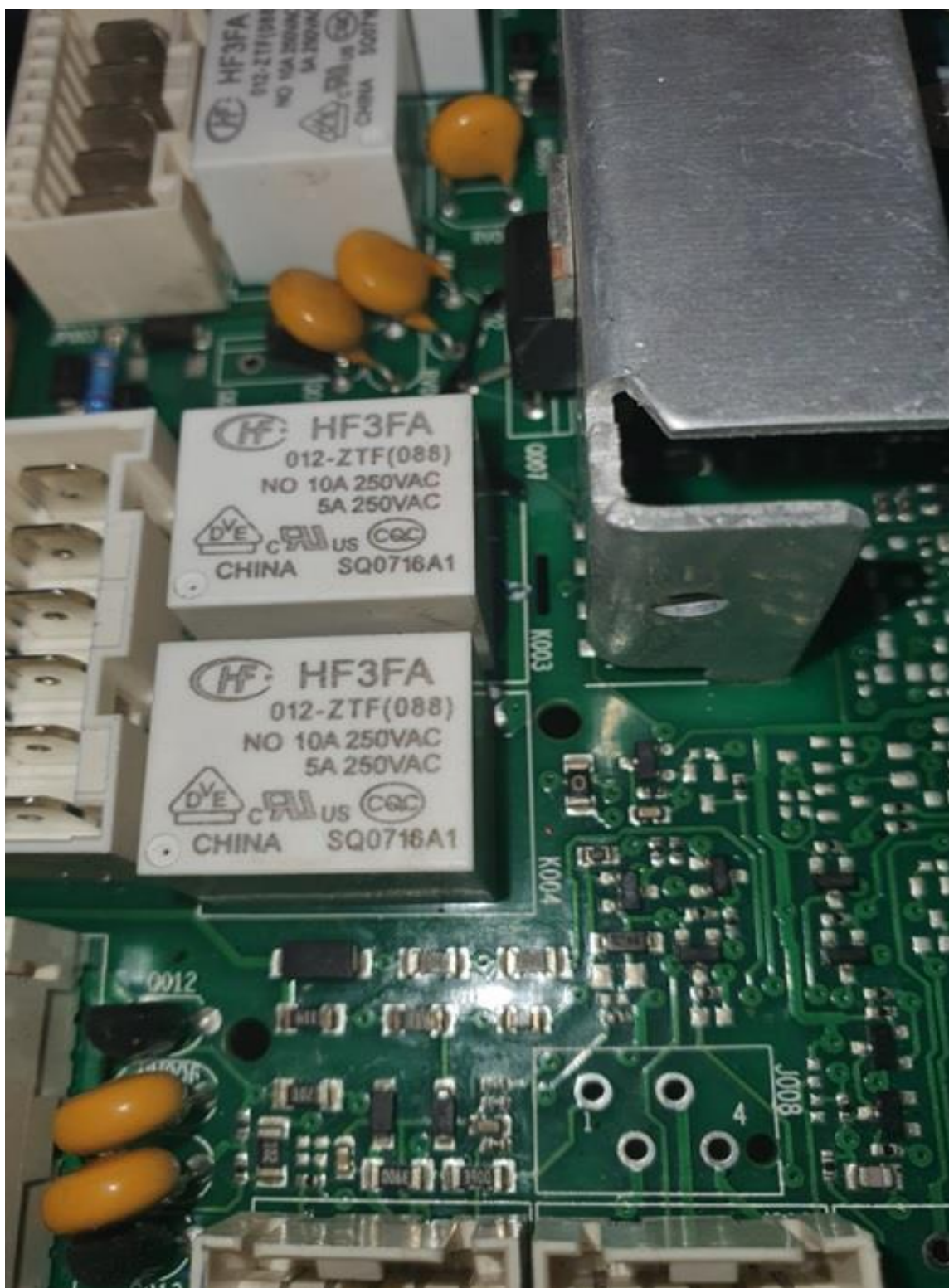
Σχήμα 1.7. Πλακέτα τυπωμένου κυκλώματος (PCB) ηλεκτρικού πλυντηρίου πιάτων [9]
