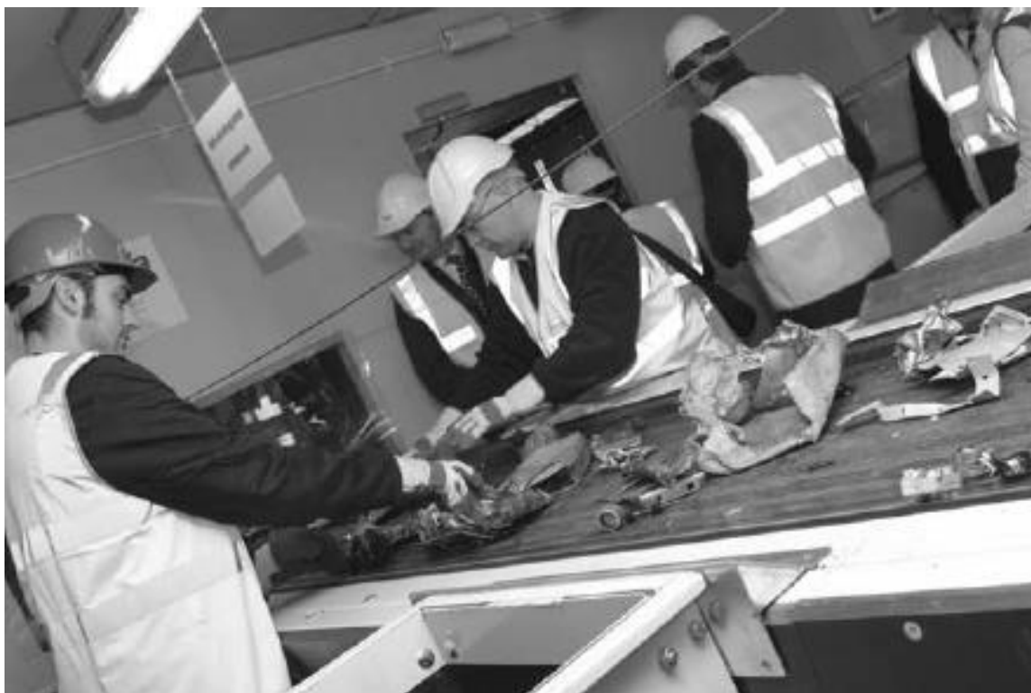
Σχήμα 2.12. Στάδιο χειροκίνητης διαδικασίας διαχωρισμού ηλεκτρονικών αποβλήτων [63]
