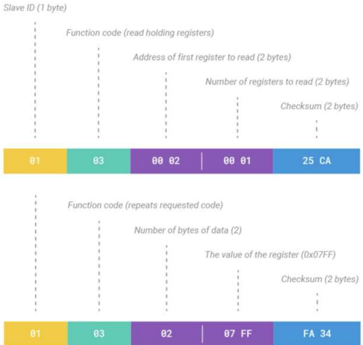
Εικόνα 3.17 Μορφή μηνύματος request-response
