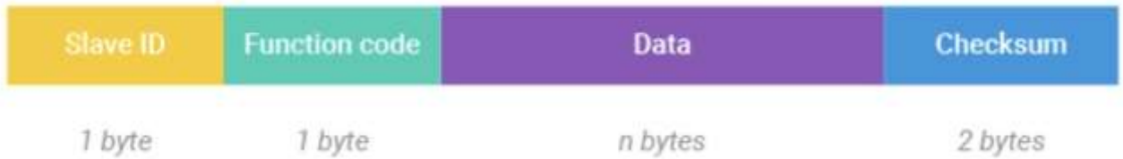
Εικόνα 3.16 Μορφή μηνύματος Modbus RTU
