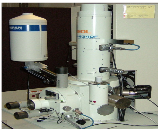
Εικόνα 1: Ηλεκτρονικό μικροσκόπιο σάρωσης Jeol 634DP Ηλεκτρονική Πηγή: https://el.wikipedia.org/wiki
