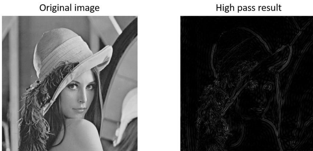
Εικόνα 2.14 Αποτέλεσμα high pass φίλτρου στο πεδίο του χώρου.
