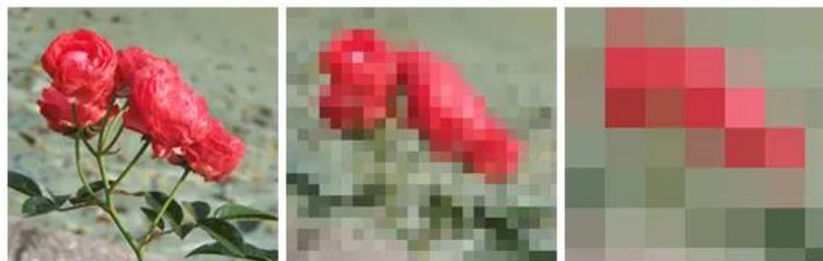
Εικόνα 2.6 Μεταβολή της ευκρίνειας μιας έγχρωμης εικόνας διατηρώντας σταθερό το βάθος χρώματος
