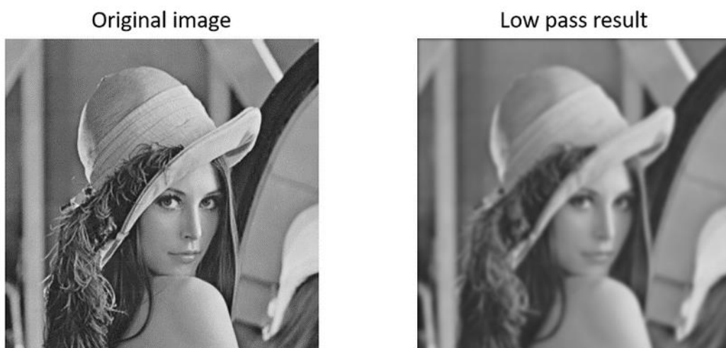
Εικόνα 2.12 Αποτέλεσμα low pass φίλτρου στο πεδίο του χώρου.
