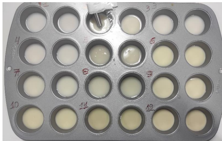
Εικόνα 3: Τοποθέτηση δειγμάτων για λυοφιλίωση
