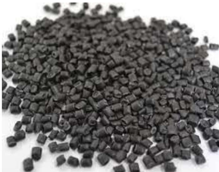
Εικόνα 12. Ανακυκλωμένοι κόκκοι πλαστικού με μηχανική τεχνολογία
